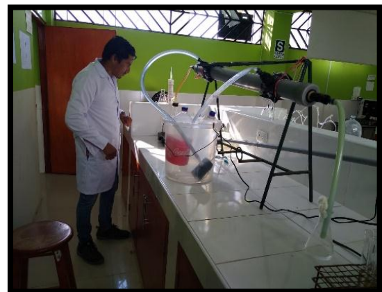
Se conectó a un condensador artesanal por 20 min de ebullición (100 °C)
