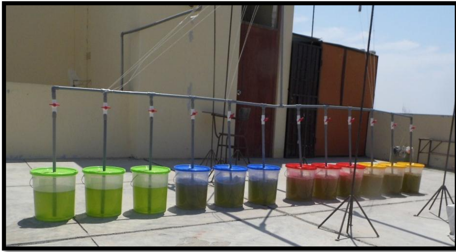
Instalación de los biorreactores para el cultivo de T. suecica
