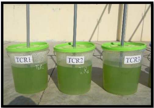
Instalación de los biorreactores para el cultivo de T. suecica
