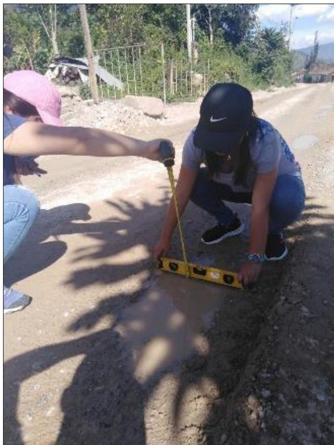
Fotografía 11. Medición de fallas por baches y presencia de erosión – Tramo III
