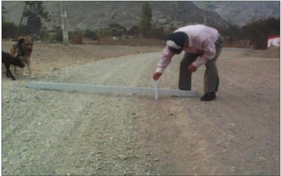
*Figura 2. Deformación Gravedad 2 - Huellas/hundimientos entre 5 cm y 10 cm*
