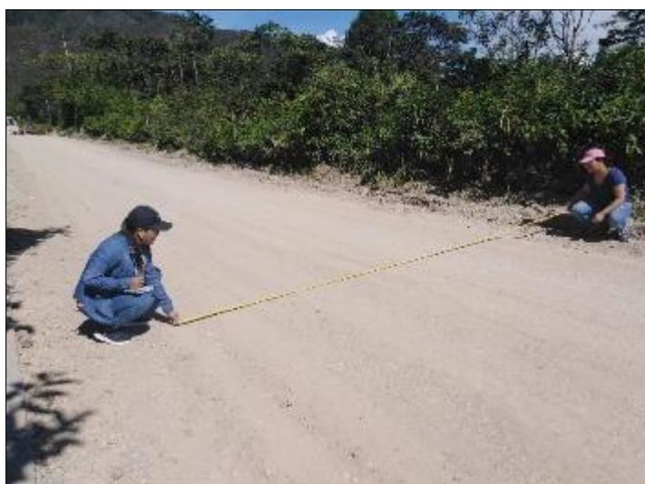
Fotografía 2. Medición de ancho de la vía en estudio del Tramo I.
