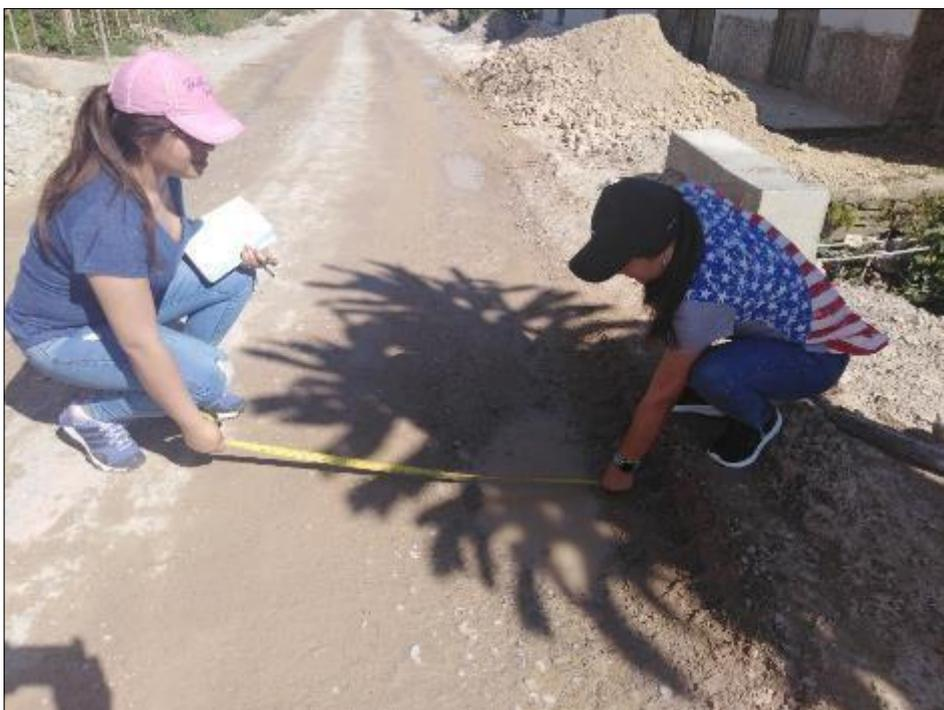
Fotografía 8. Medición de fallas por huellas, baches y erosión – Tramo II
