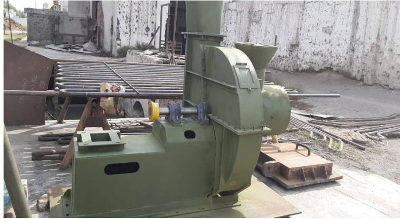
Foto N° 3.- Fabricacion del Ventilador de aire sobrefuego
