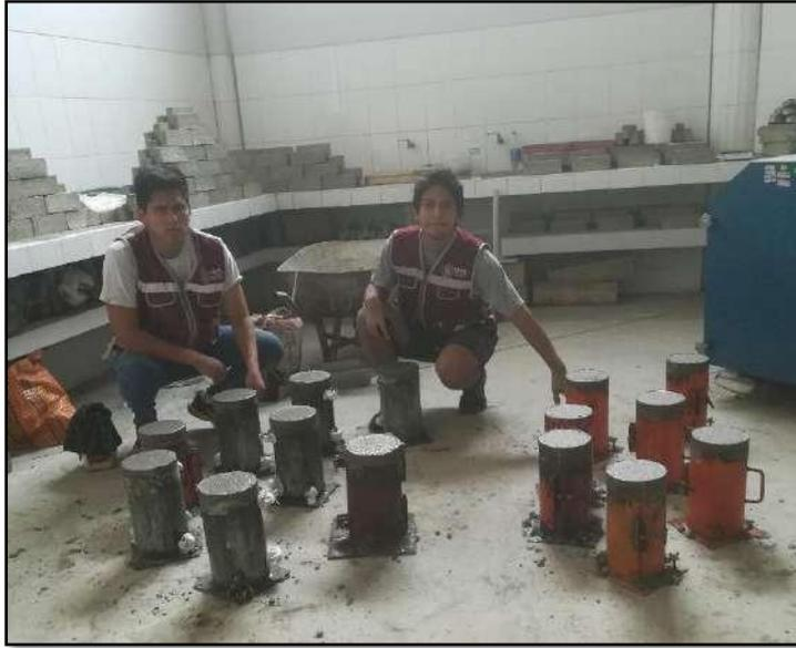
Fraguado del Concreto Autocompactante durante 24 horas.
