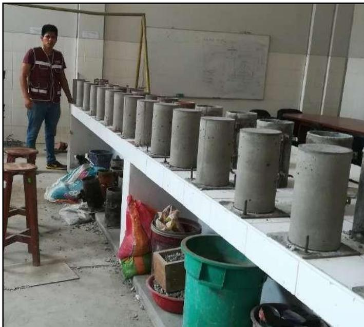
Desencofrado de los especímenes de concreto.
