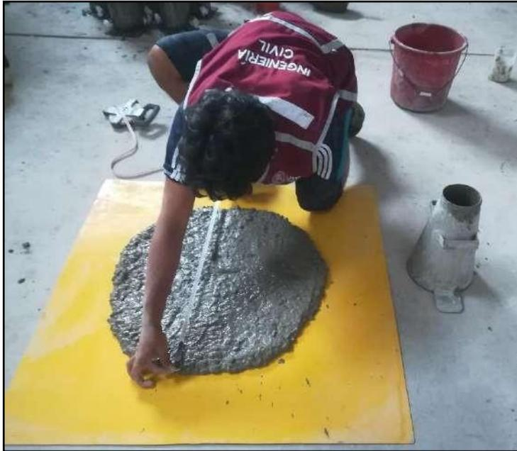
Vista de la medición del diámetro alcanzado en el ensayo de Extensión de Flujo.
