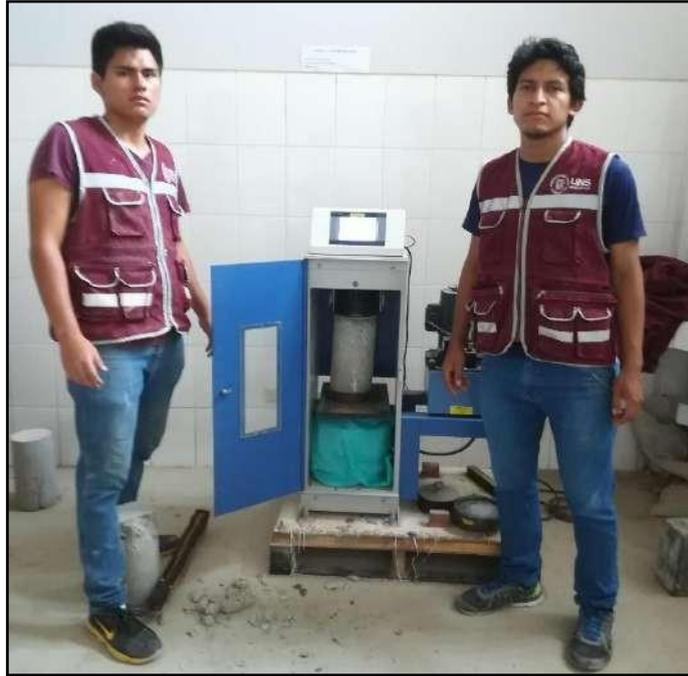
Rotura de testigos de concreto en la maquina electro-hidráulica, para la obtención de la resistencia a la compresión.
