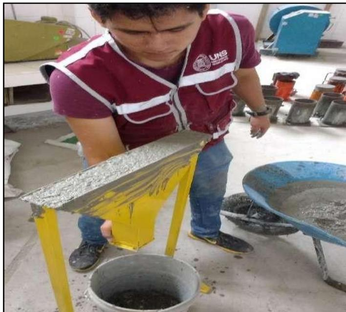
Llenado del Embudo V completamente con concreto sin compactar, enrazado ligeramente.
