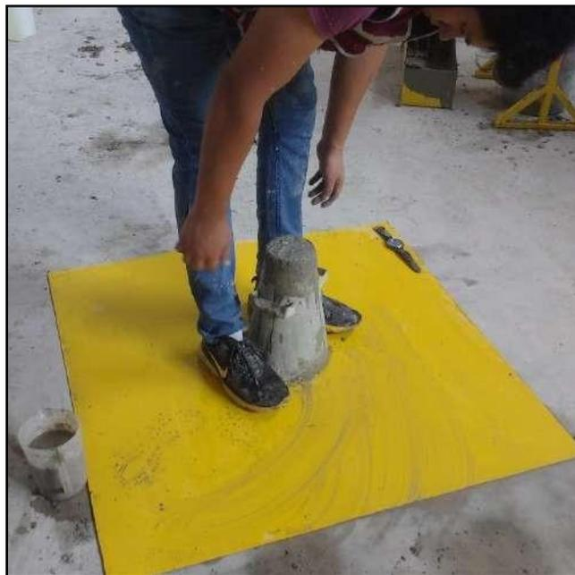
Llenado del cono con la mezcla, sujetándolo firmemente y enrazado.
