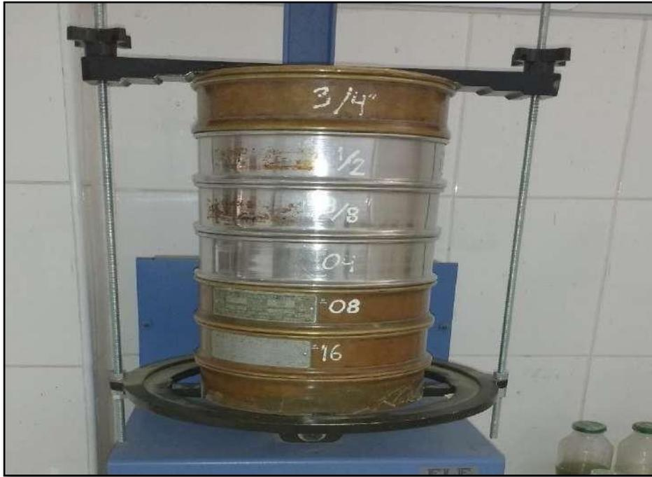
Tamizado para calcular la granulometría del agregado grueso.
