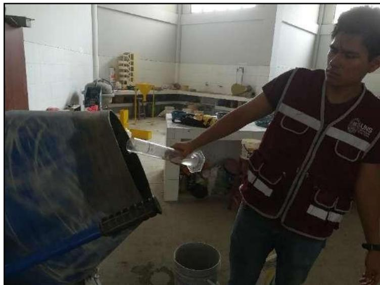
Vertido de la Nanosílice en la mezcla de concreto.
