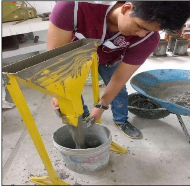
Abriendo la puerta de la base y controlando el tiempo que demora en descargar el concreto.
