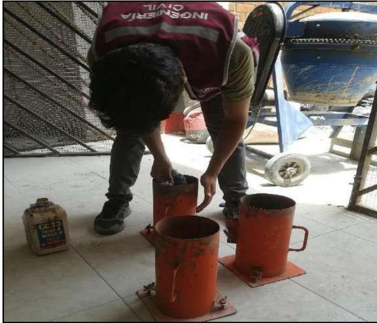
Colocación de petróleo como desmoldante en las probetas.
