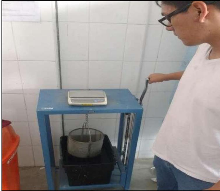
Determinando el peso de la muestra saturada dentro del agua + peso de la canastilla.
