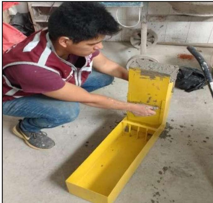
Llenado de la sección vertical de la Caja L con la muestra de concreto.
