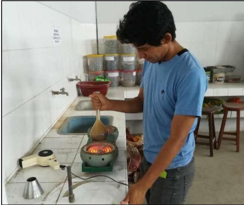
Calentamiento del picnómetro+agua+muestra para eliminar los espacios vacíos.
