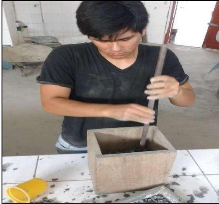
Compactando en capas el agregado grueso para calcular el Peso Unitario Compactado.
