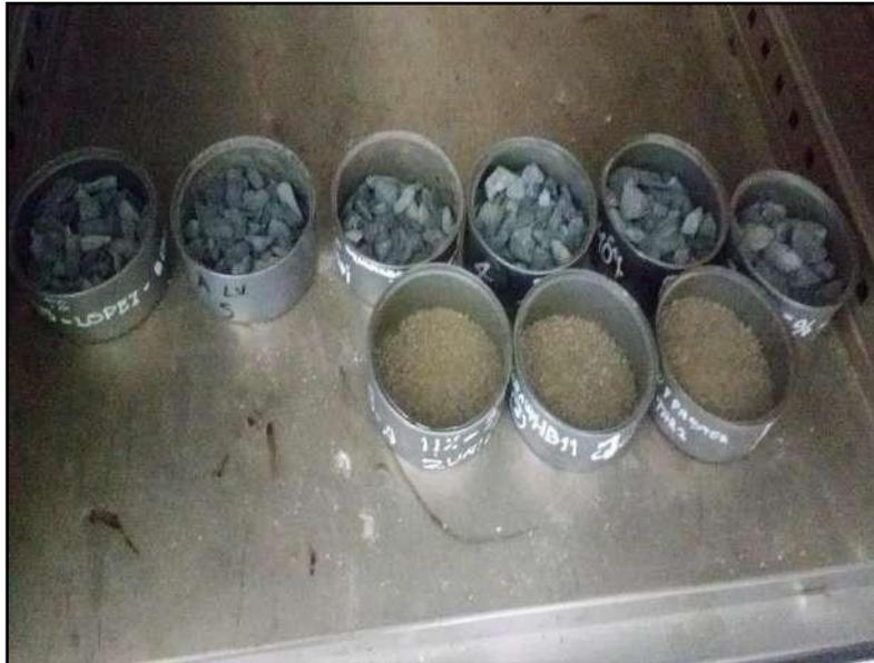
Secando las muestras de agregado para determinar el contenido de humedad.
