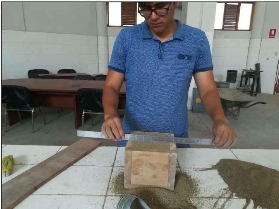
Enrazando el agregado fino para calcular el Peso Unitario Suelto.
