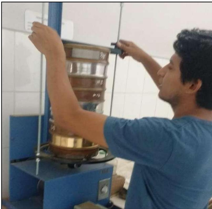
Tamizado para calcular la granulometría del agregado fino.
