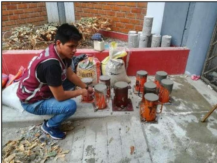
Fraguado del Concreto Patrón durante 24 horas.
