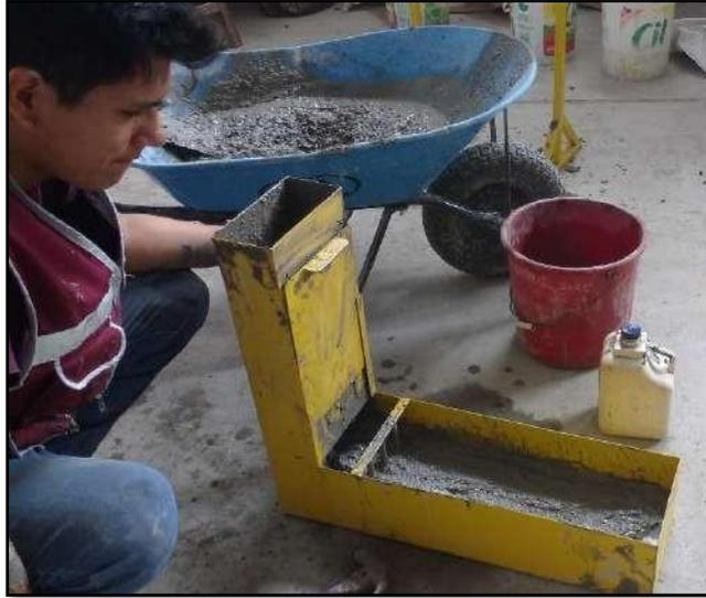
Vista de la compuerta abierta, y la mezcla extendida, lista para la posterior medición de las alturas en cada extremo de la sección horizontal.
