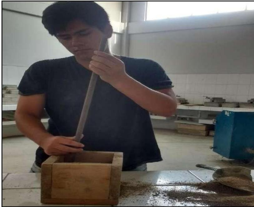
Compactando en capas el agregado fino para calcular el Peso Unitario Compactado.
