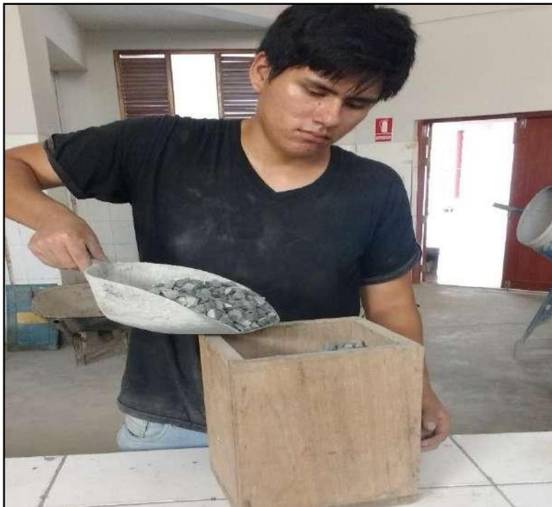
Llenando el recipiente de madera con agregado grueso para calcular el Peso Unitario Suelto.
