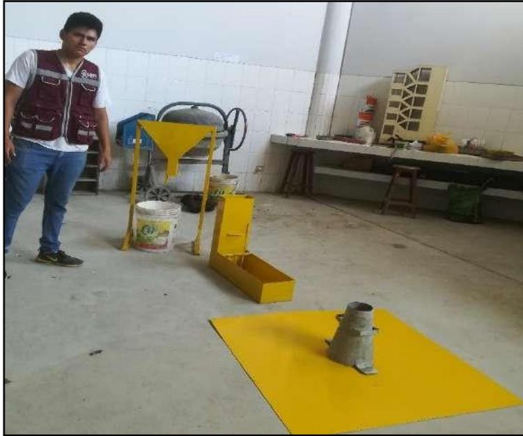
Vista de los aparatos limpios y humectados, listos para los ensayos del concreto en estado fresco.
