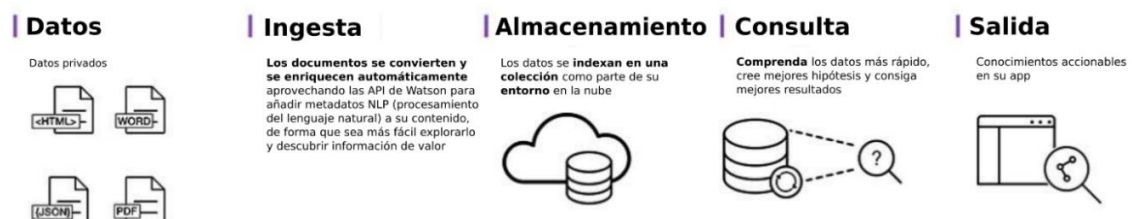
Figura 10: Arquitectura del servicio Discovery: (IBM Cloud, 2019)
