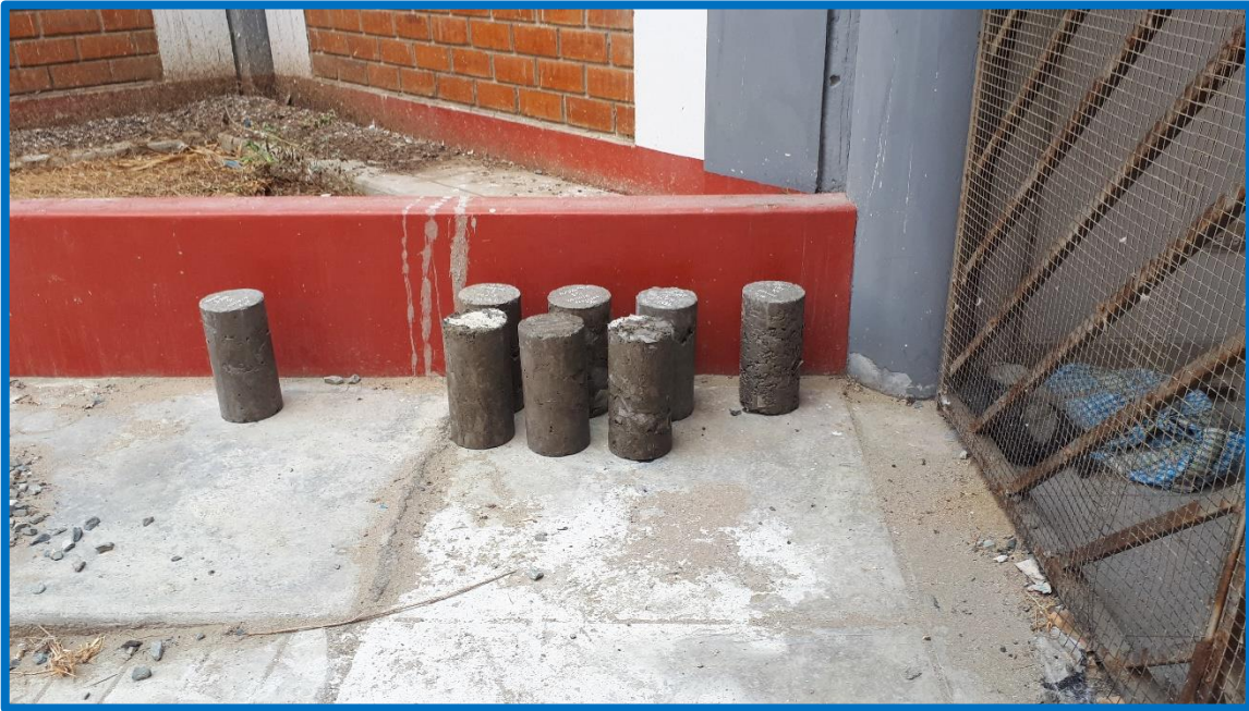
Foto N.º 54.- Testigos de concreto para F'c= 175 \text{ kg/cm}^2 y F'c=210 \text{ kg/cm}^2 . F'c=280 \text{ kg/cm}^2 luego del curado, dejando secar para posterior prueba a la rotura para verificación de las resistencias de diseño.
