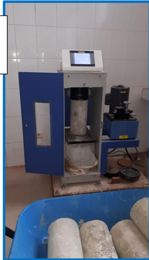
Foto N.º 56.- Resultados de Ensayo de Resistencia a la compresión, se presenta la falla en el testigo de concreto.
