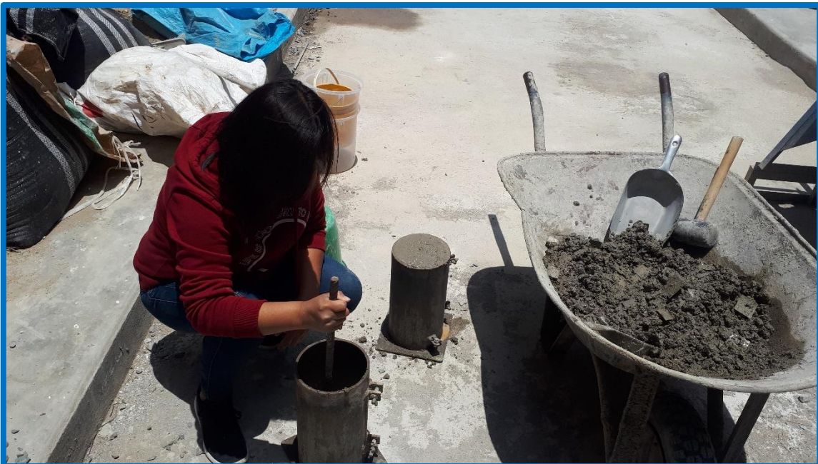
Foto N.º 47.- Preparación de testigos de concreto para F'c=175 \text{ kg/cm}^2 y F'c=210 \text{ kg/cm}^2 . F_c'=280 \text{ kg/cm}^2 con 1% de PET.
