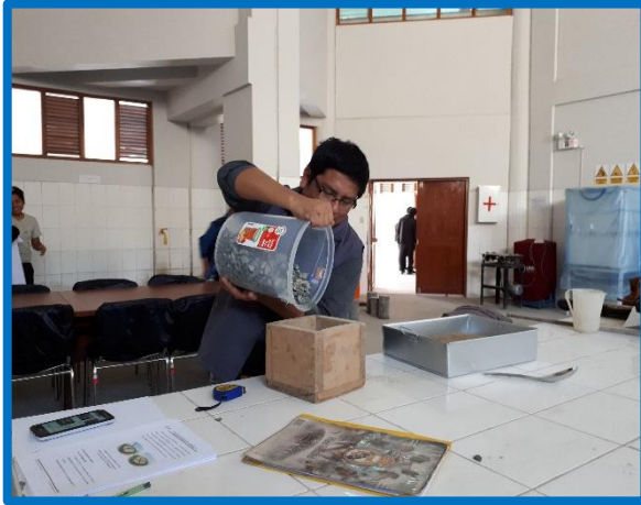
Foto N.º 08. -Una vez de obtenidas las muestras del agregado grueso y fino, se procede a pesarlas en estado suelto en un recipiente de dimensiones conocidas.
