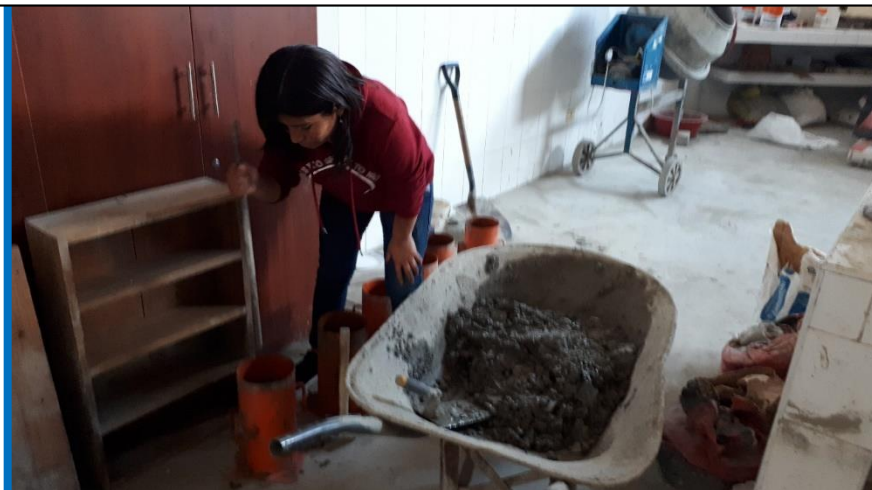
Foto N.º 47.- Preparación de testigos de concreto para F'c=175 \text{ kg/cm}^2 y F'c=210 \text{ kg/cm}^2 . F_c'=280 \text{ kg/cm}^2 con 1% de PET.
