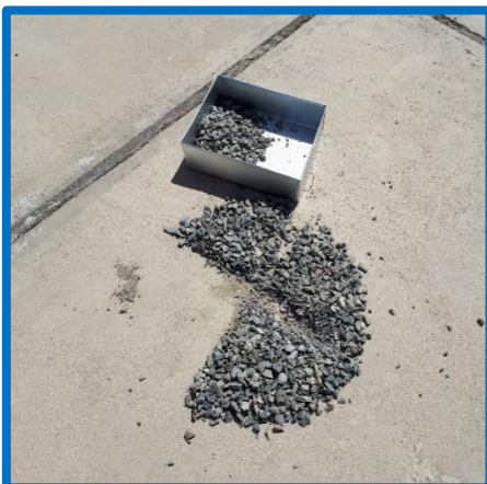
Foto N.º 06. -Cuarteado de las muestras de agregado grueso y fino, para diseño de mezcla
