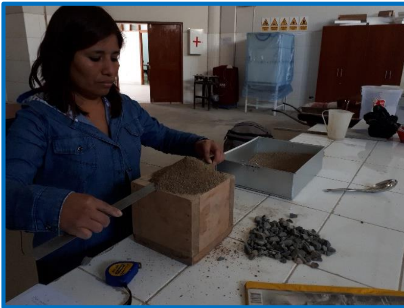
Foto N.º 11.- Colocacion de la muestra de agregado fino en recipiente de dimensiones conocidas, llenando hasta el ras del recipiente.
