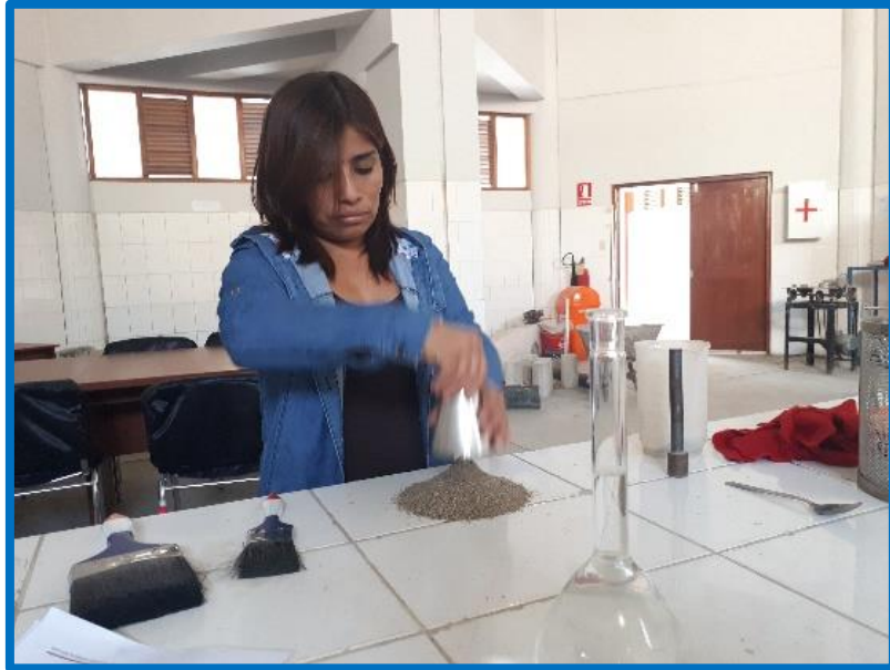
Foto N.º 32.- verificacion que no hay humedad en el material de agregado fino.
