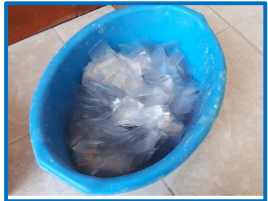
Foto N.º 04. -Laminas PET en forma cuadrada de 3, 4 y 5 cm
