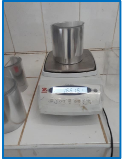
Foto N° 03. -Peso de láminas PET a utilizar para los tamaños de 3, 4 y 5 cm de forma cuadrada.
