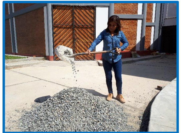
Foto N.º 05. -Mezcla del material agregado grueso y fino previo a sacar la muestra para el diseño de mezcla.
