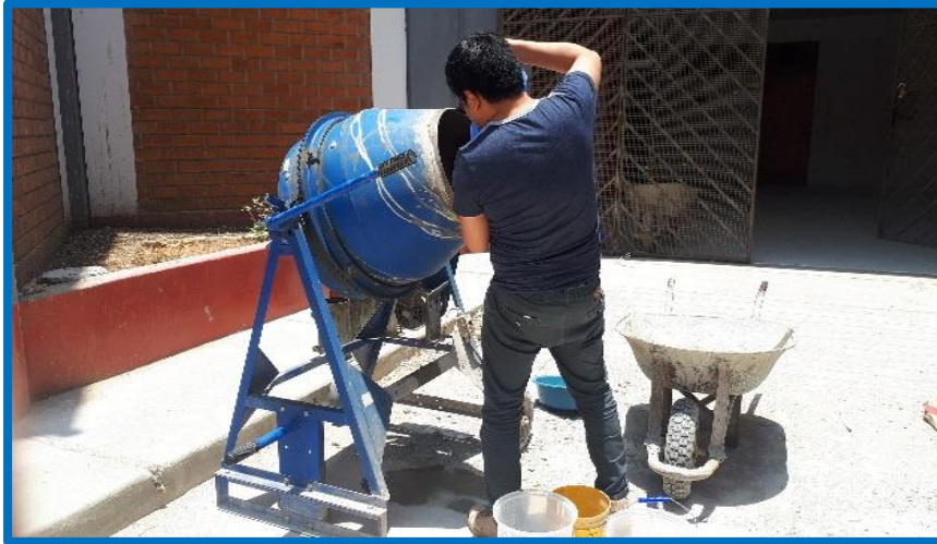
Foto N.º 46.- Preparación de testigos de concreto para F'c=175 \text{ kg/cm}^2 y F'c=210 \text{ kg/cm}^2 . F_c'=280 \text{ kg/cm}^2 .
