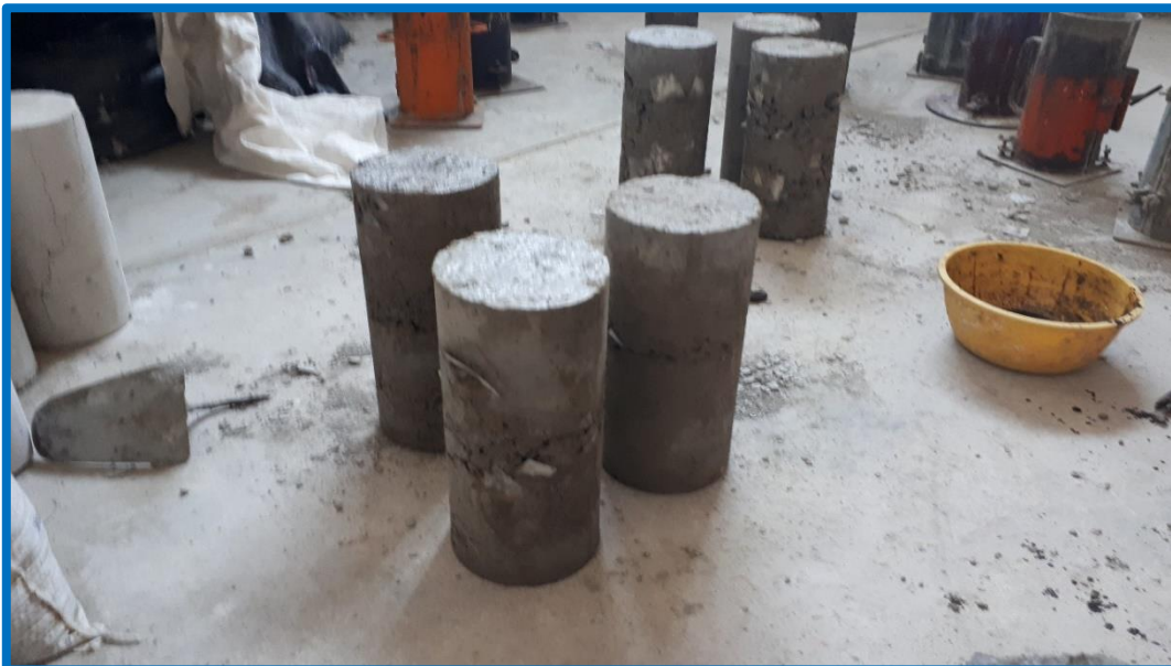
Foto N.º 51.- Testigos de concreto para F'_c = 175 kg/cm 2 y F'_c = 210 kg/cm 2 . F'_c = 280 kg/cm 2 con 1% de PET.
