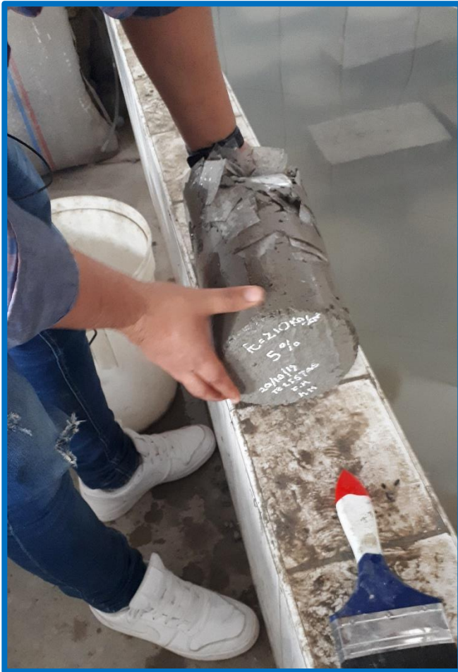
Foto N.º 50.- Curado de Testigos de concreto para F'_c = 175 kg/cm 2 y F'_c = 210 kg/cm 2 . F'_c = 280 kg/cm 2 con 1%, 3% y 5% de PET.
