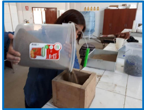
Foto N.º 08. -Una vez de obtenidas las muestras del agregado grueso y fino, se procede a pesarlas en estado suelto en un recipiente de dimensiones conocidas.
