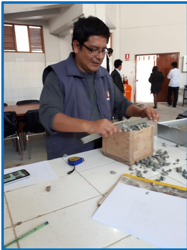
Foto N.º 09. -Colocacion de la muestra de agregado grueso en recipiente de dimensiones conocidas, llenando hasta el ras del recipiente.
