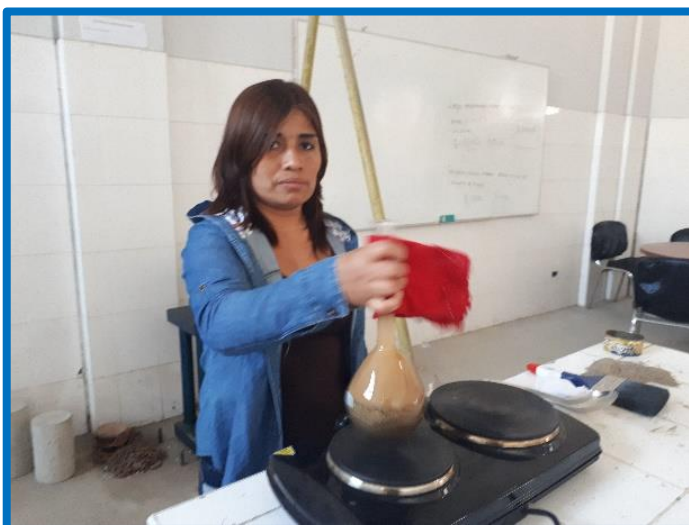
Foto N.º 37.- Peso de la muestra más agua más frasco.
