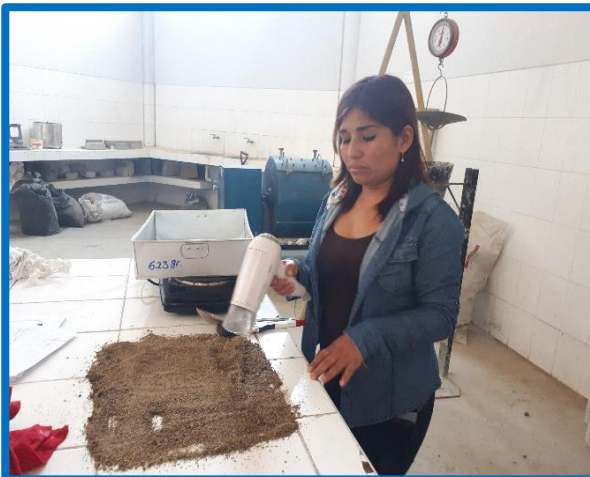
Foto N.º 30. -Secado de los agregados, esparciendo el material sobre la mesada expuesta a una corriente de aire tibia.
