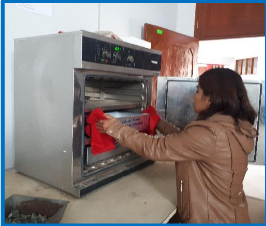
Foto N.º 29. -Luego de 24 horas se retiraron las muestras y sumergieron en agua para su saturación por 24 horas.
