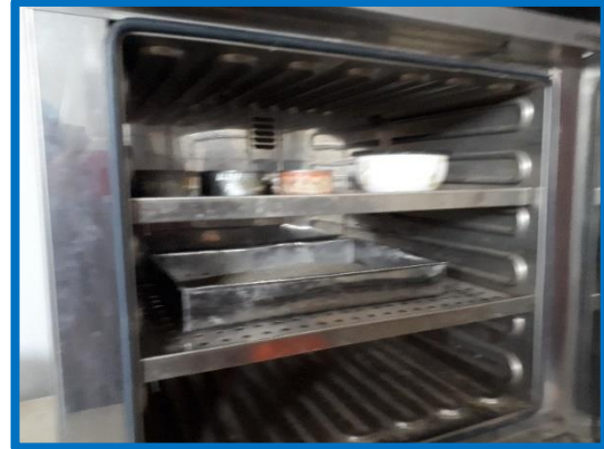
Foto N.º 38.- Pesada la muestra, se retiro el liquido y coloco el material en un recipiente y llevado al horno con peso constante a una temperatura de 110 \pm 5 °C.
