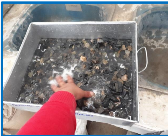
Foto N.º 27. -Peso de las muestras, 1kg para el agregado fino y una muestra de 3 kg para el agregado grueso, retirando el material que paso el tamiz N°4 .
