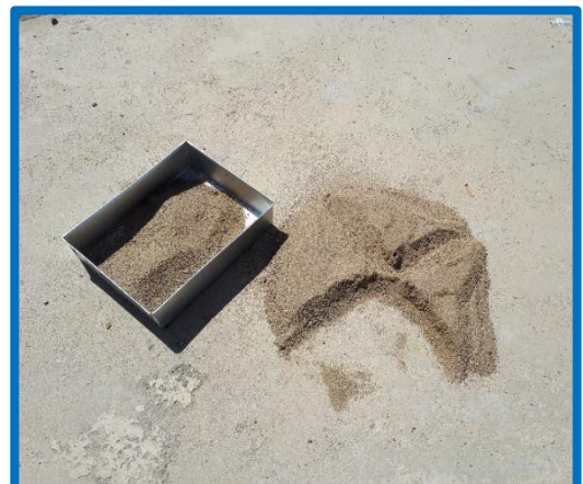
Foto N.º 06. -Cuarteado de las muestras de agregado grueso y fino, para diseño de mezcla
