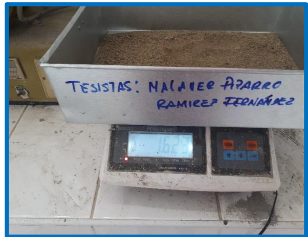
Foto N.º 27. -Peso de las muestras, 1kg para el agregado fino y una muestra de 3 kg para el agregado grueso, retirando el material que paso el tamiz N°4 .
