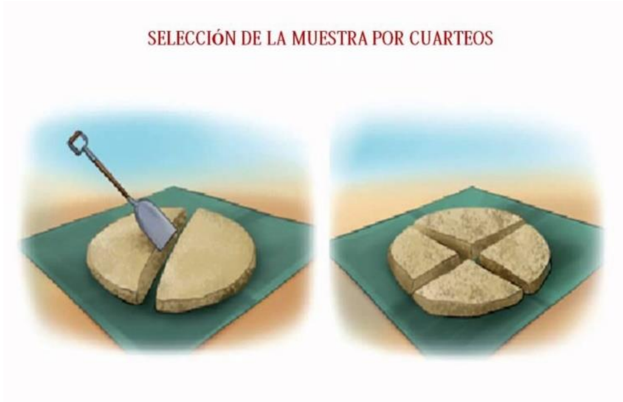
Figura 3. Cuarteo en una superficie plana y limpia
