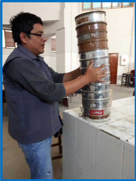
Foto N.º 22.- Numero de tamices utilizados para el tamizado del material fino.
