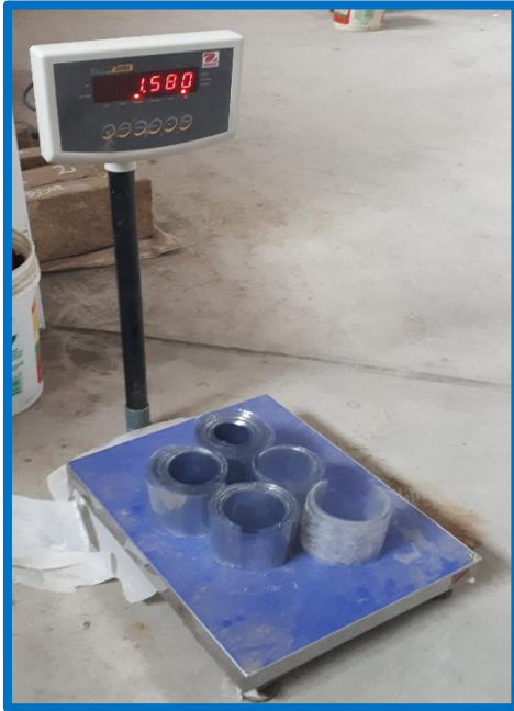
Foto N° 03. -Peso de láminas PET a utilizar para los tamaños de 3, 4 y 5 cm de forma cuadrada.
