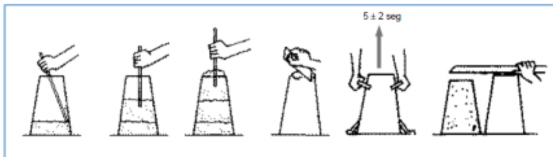
Figura 6. "Procedimiento para el asentamiento del concreto fresco"
