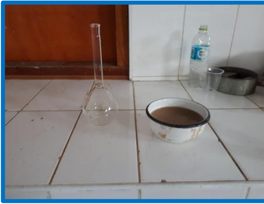
Foto N.º 38.- Pesada la muestra, se retiro el liquido y coloco el material en un recipiente y llevado al horno con peso constante a una temperatura de 110 \pm 5 °C.
