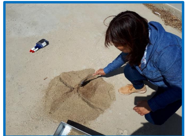
Foto N.º 06. -Cuarteado de las muestras de agregado grueso y fino, para diseño de mezcla
