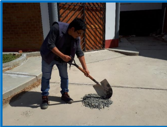
Foto N.º 06. -Cuarteado de las muestras de agregado grueso y fino, para diseño de mezcla
