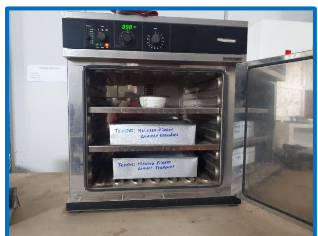
Foto N.º 28. -Secado de la muestra al horno a una temperatura de 110\text{ }^{\circ}\text{C} \pm 5\text{ }^{\circ}\text{C} , por un periodo de 24 h.
