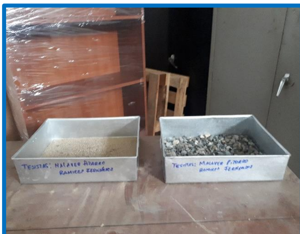
Foto N.º 28. -Secado de la muestra al horno a una temperatura de 110\text{ }^{\circ}\text{C} \pm 5\text{ }^{\circ}\text{C} , por un periodo de 24 h.
