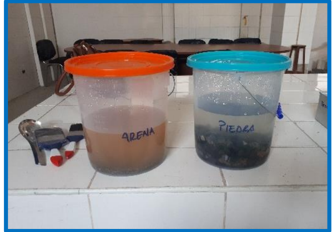
Foto N.º 29. -Luego de 24 horas se retiraron las muestras y sumergieron en agua para su saturación por 24 horas.
