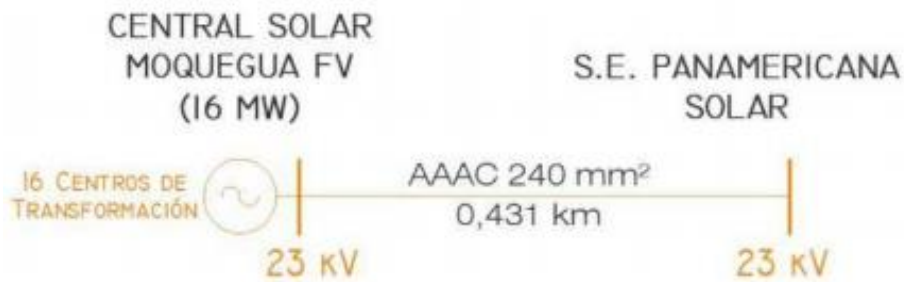
Figura 19 Diagrama unifilar de conexión al SEIN de Central fotovoltaica de Moquegua. Fuente: Osinergmin (2020)
