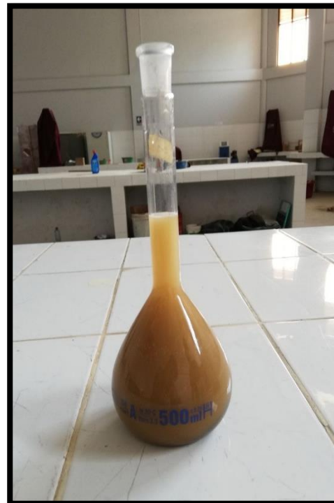
REALIZACION DEL ENSAYO DE PESO ESPECIFICO Y ABSORCION DEL
