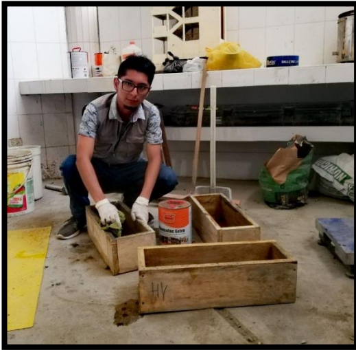
LIMPIEZA Y APLICACIÓN DE ADITIVO DESMOLDANTE EN EL ENCOFRADO DE
