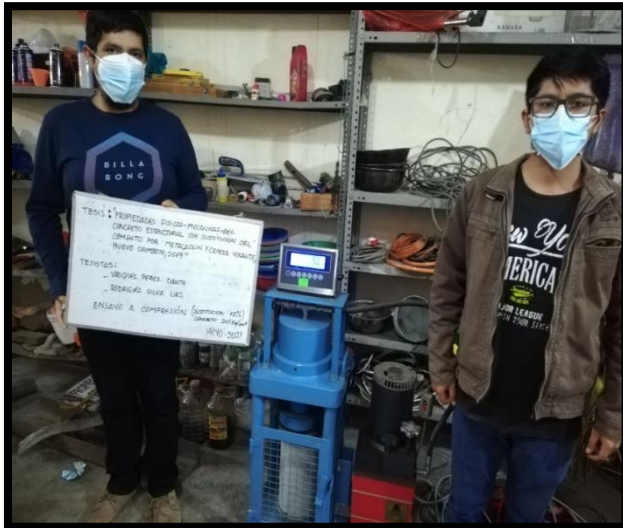
ENSAYO DE LA RESISTENCIA A LA COMPRESIÓN DEL CONCRETO CON SUSTITUCION DEL 10% DEL CEMENTO POR CV Y MK, A LOS 28 DIAS DE CURADO, PARA LA DESVIACIÓN ESTANDAR
