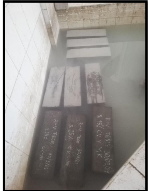
DESENCOFRADO Y CURADOS DE LAS VIGAS
