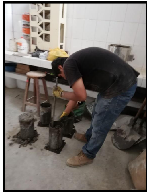
VACIADO Y VARILLADO RESPECTIVO DE LAS PROBETAS
