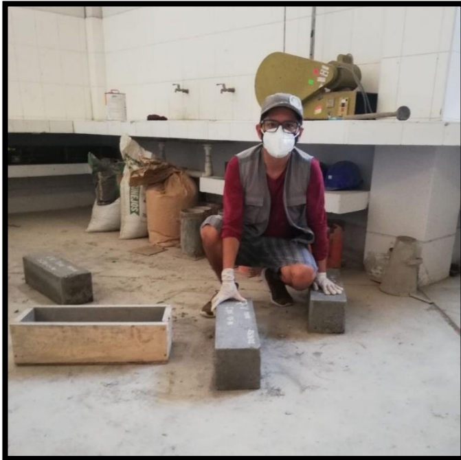
DESENCOFRADO Y CURADOS DE LAS VIGAS
