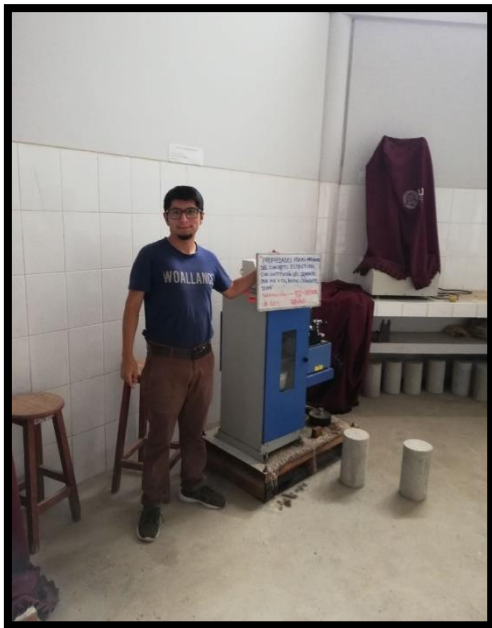
ENSAYO DE LA RESISTENCIA A LA COMPRESION DEL CONCRETO CON SUSTITUCION DEL 5% DEL CEMENTO POR CV Y MK, A LOS 7,
