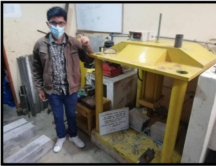
ENSAYO A LA FLEXION DEL CONCRETO CON SUSTITUCION DEL 5% DEL CEMENTO POR CV Y MK A LOS 28 DIAS DE CURADO
