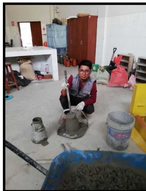
REALIZANDO LA PRUEBA DEL SLUMP DEL CONCRETO EN ESTADO FRESCO PARA LAS PROBETAS
