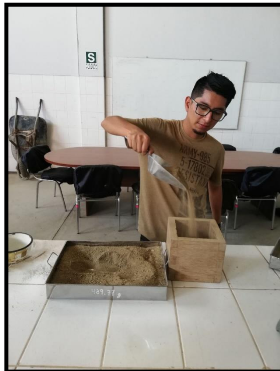
CALCULANDO EL PESO SUELTO DEL AGREGADO FINO
