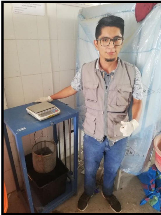
REALIZACION DEL ENSAYO DE PESO ESPECIFICO Y ABSORCION DEL
