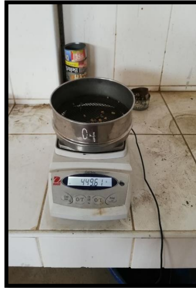
PESANDO LAS MUESTRAS RETENIDAS EN LAS MALLAS
