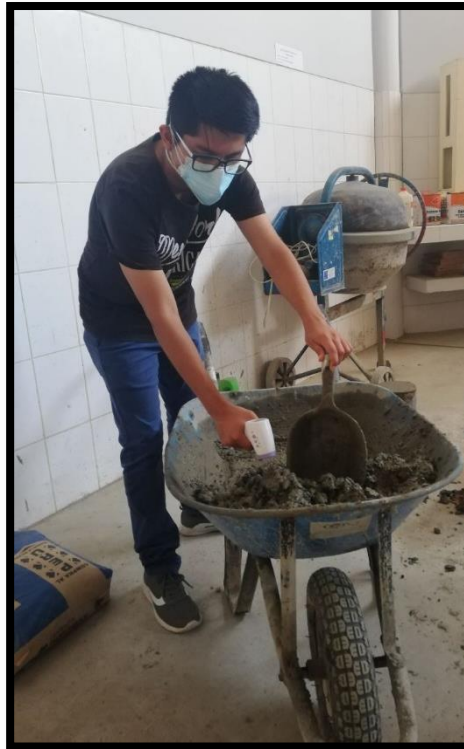
TOMA DE TEMPERATURA DEL CONCRETO EN ESTADO FRESCO PARA LAS VIGAS
