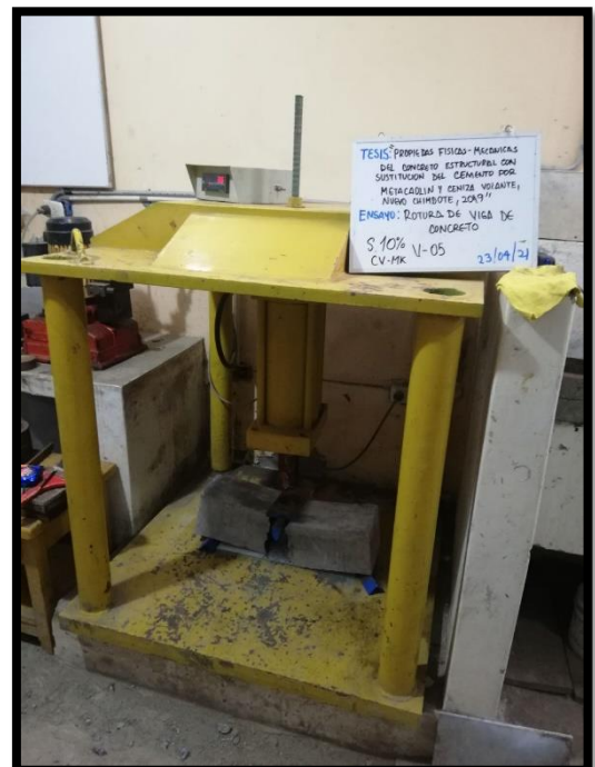
ENSAYO A LA FLEXION DEL CONCRETO CON SUSTITUCION DEL 10% DEL CEMENTO POR CV Y MK A LOS 28 DIAS DE CURADO
