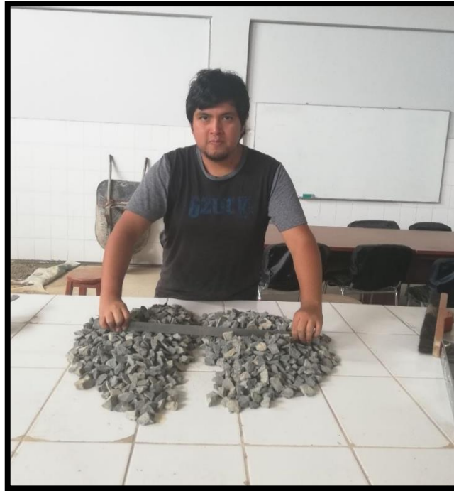
REALIZACION DEL CUARTEO DEL AGREGADO GRUESO
