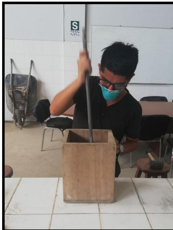
VARILLADO DEL AGREGADO GRUESO PARA EL ENSAYO DE PESO UNITARIO
