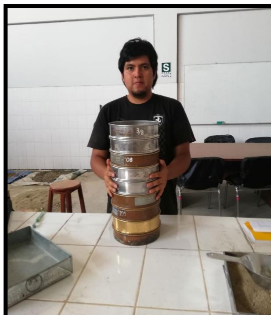
REALIZACION DEL TAMIZAJE DE LOS AGREGADOS
