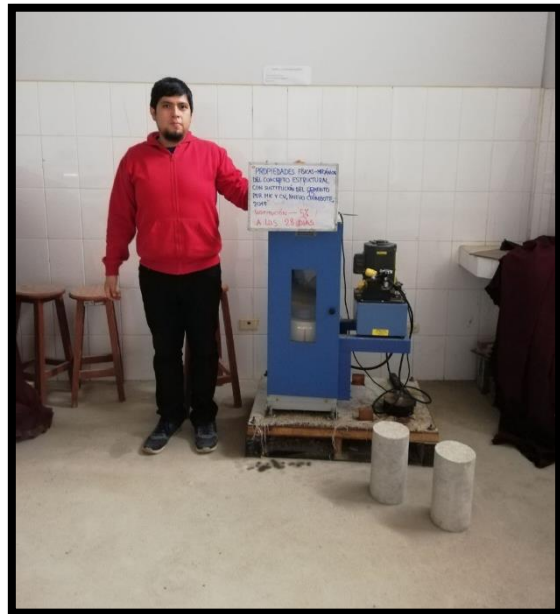
ENSAYO DE LA RESISTENCIA A LA COMPRESION DEL CONCRETO CON SUSTITUCION DEL 5% DEL CEMENTO POR CV Y MK, A LOS 7,
