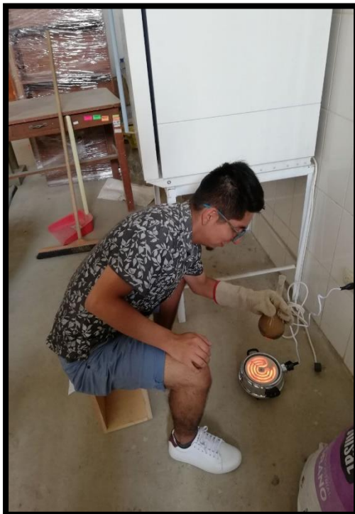
REALIZACION DEL ENSAYO DE PESO ESPECIFICO Y ABSORCION DEL
