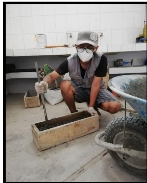
VACIADO Y VARILLADO RESPECTIVO DE LAS VIGAS
