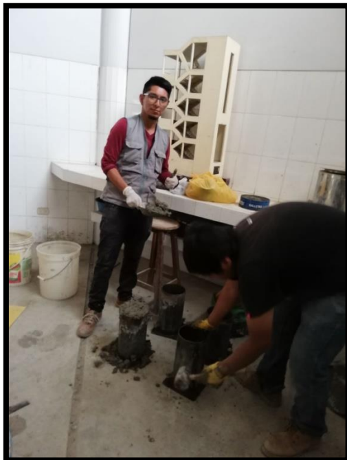
VACIADO Y VARILLADO RESPECTIVO DE LAS PROBETAS
