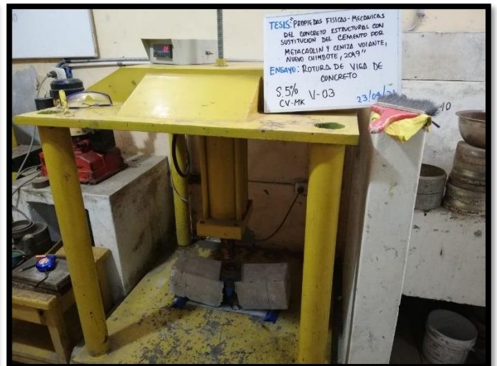
ENSAYO A LA FLEXION DEL CONCRETO CON SUSTITUCION DEL 5% DEL CEMENTO POR CV Y MK A LOS 28 DIAS DE CURADO
