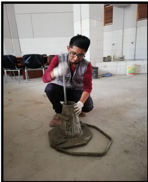
REALIZANDO LA PRUEBA DEL SLUMP DEL CONCRETO EN ESTADO FRESCO PARA LAS PROBETAS
