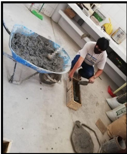
VACIADO Y VARILLADO RESPECTIVO DE LAS VIGAS
