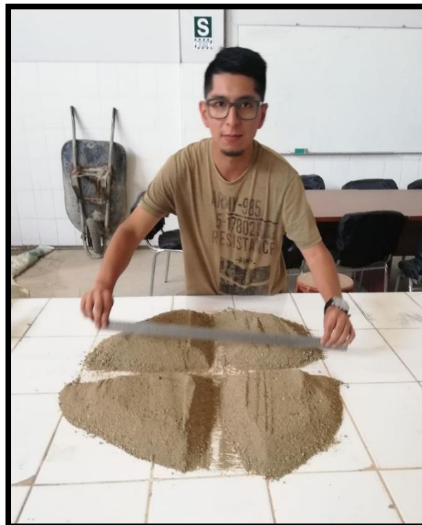
REALIZACION DEL CUARTEO DEL AGREGADO FINO
