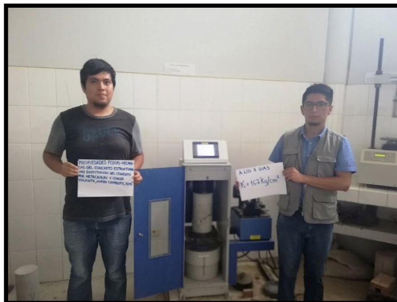
ENSAYO DE LA RESISTENCIA A LA COMPRESION DEL CONCRETO PATRON A LOS 7 DIAS DE CURADO
