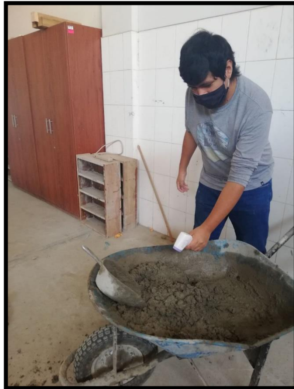
TOMA DE TEMPERATURA DEL CONCRETO EN ESTADO FRESCO PARA LAS PROBETAS
