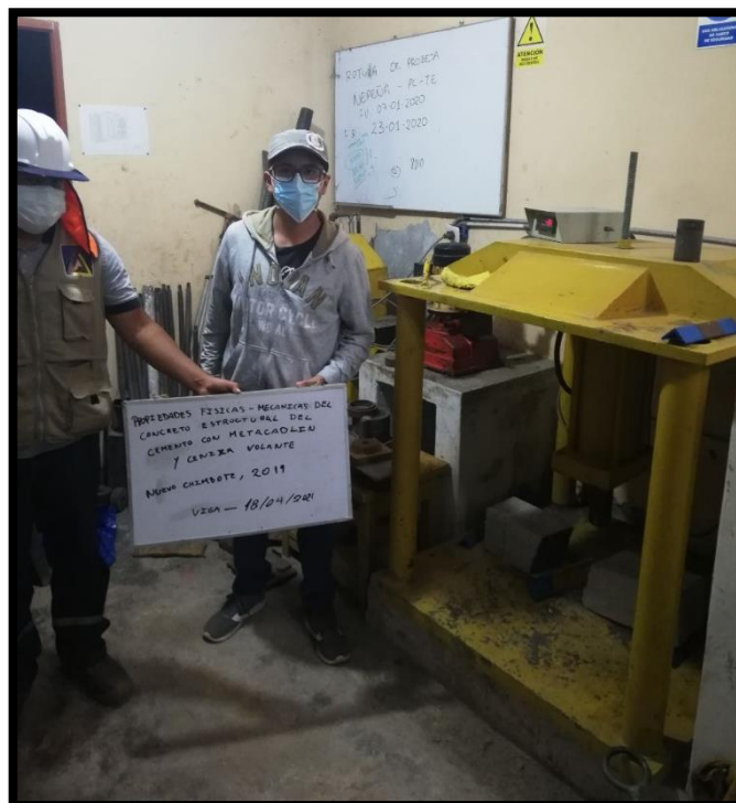
ENSAYO A LA FLEXION DEL CONCRETO PATRON A LOS 28 DIAS DE CURADO
