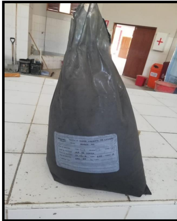
MUESTRA CENIZA VOLANTE DE LA PLANTA TERMoeLECTRICA ILO21
