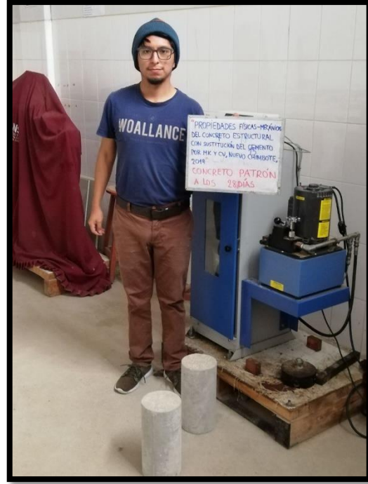
ENSAYO DE LA RESISTENCIA A LA COMPRESION DEL CONCRETO PATRON A LOS 14 Y 28 DIAS DE
