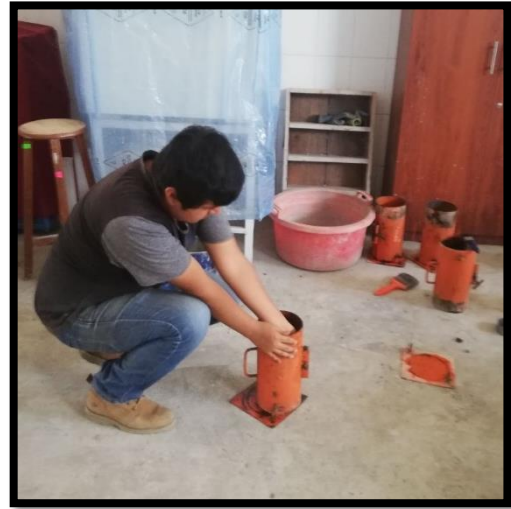
LIMPIEZA Y APLICACIÓN DE ADITIVO DESMOLDANTE EN EL ENCOFRADO DE
