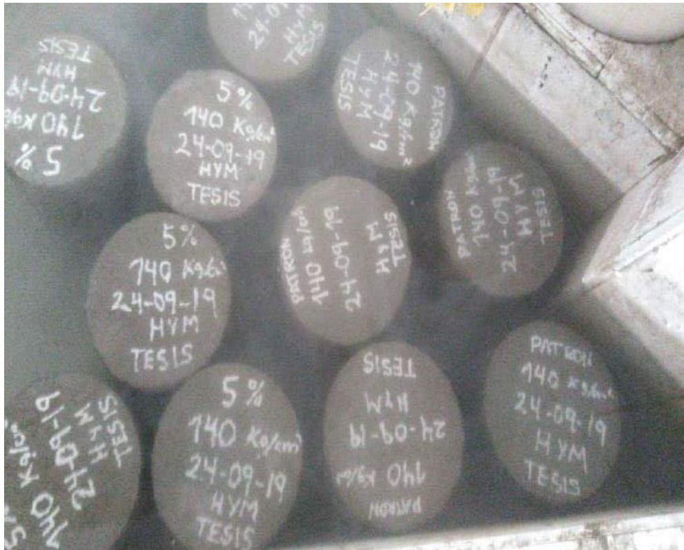
Figura 16. Curado de Concreto en el laboratorio de la Universidad Nacional del Santa.
