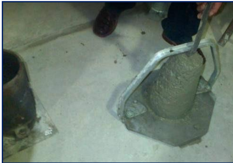
FOTOGRAFÍA N° 19 Revisión de slump utilizando cono de Abrams.
