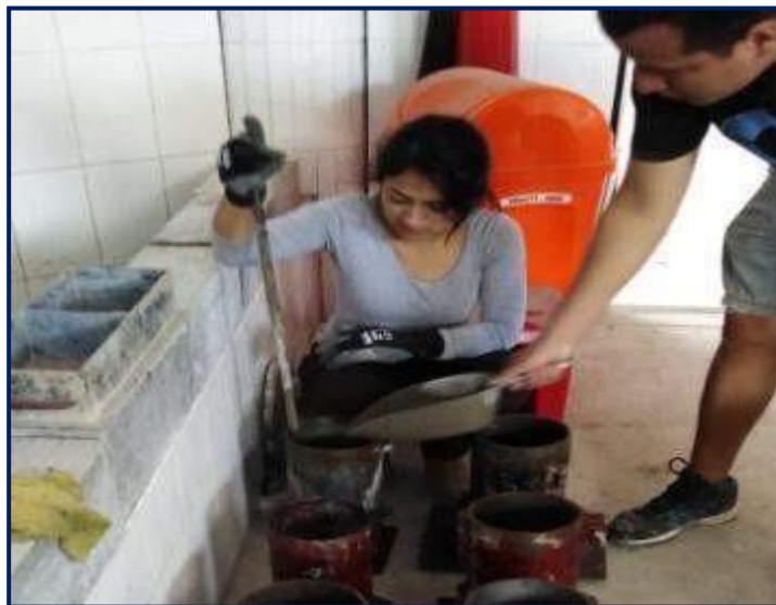
FOTOGRAFÍA N° 20 Vaciado de Concreto con residuos de maíz calcinado.
