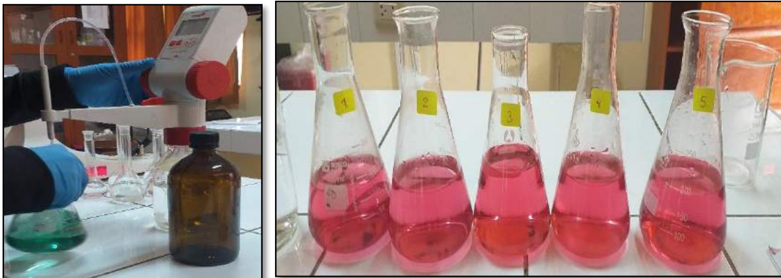
Figura 56. Titulación de las muestras con solución de HCl 0.1 N, valoración hasta cambiar de color rosa
