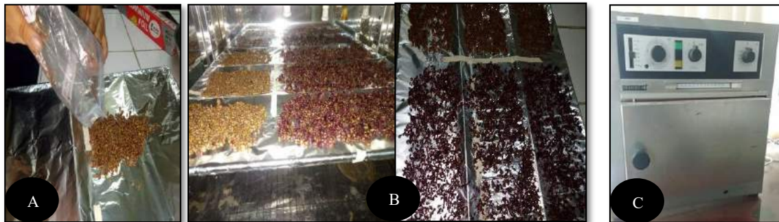
Figura 37. Secado por estufa de la semilla de uva A) Acondicionamiento de la semilla en la bandeja B) colocacion de la bandeja en el secador C) Estufa
