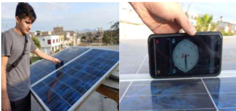
Figura 11: Medición de Inclinación de los Módulos Fotovoltaicos.
