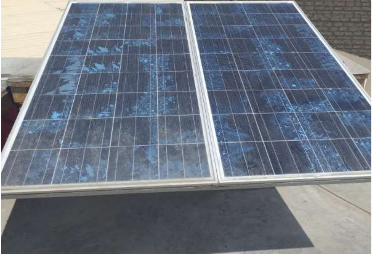
Figura 31: Módulo Polvoriento y de Referencia en el último día de medición.
