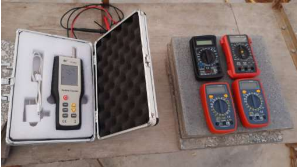
Figura 32: Instrumentos de medición: Air Quality Detector, Multitesters.
