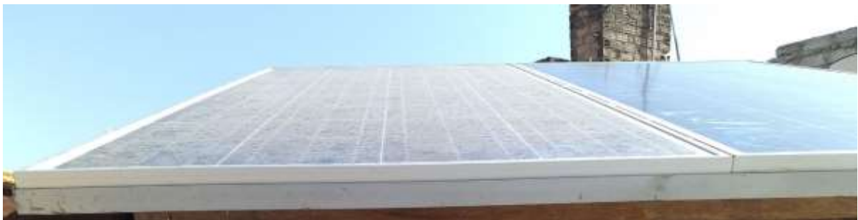
Figura 28: Módulo Polvoriento y Módulo de Referencia.
