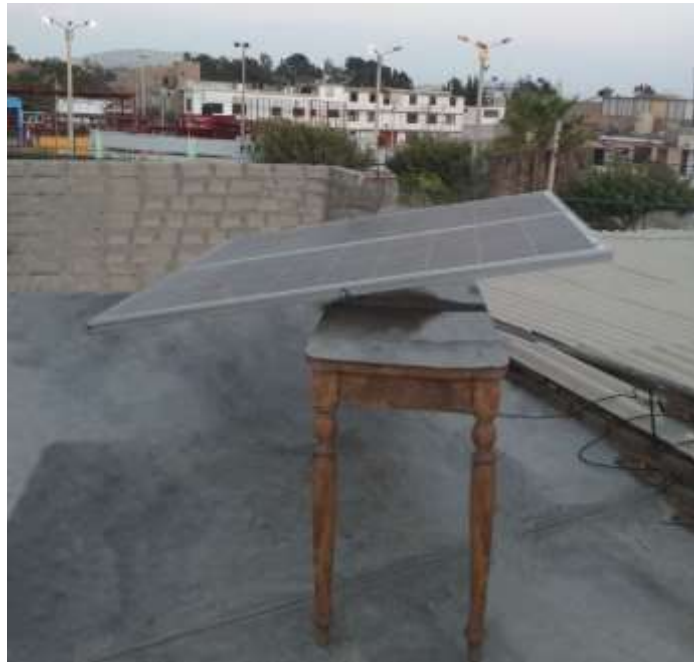
Figura 16: Inclinación de 10^\circ de los Módulos Fotovoltaicos.
