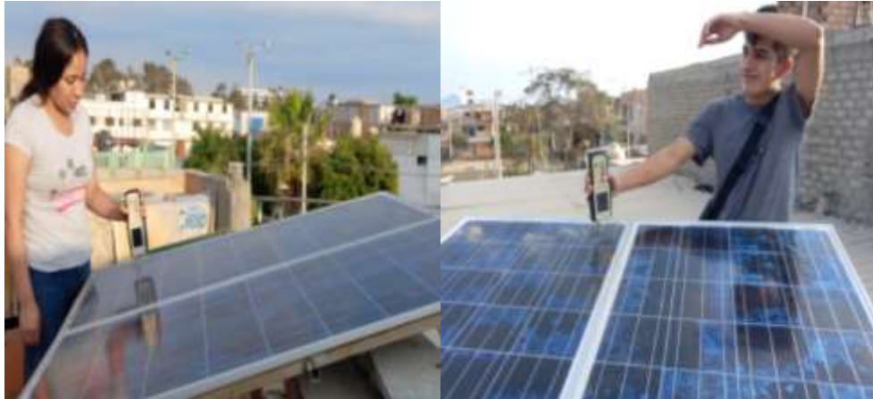
Figura 14: Medición de Partículas de Polvo.
