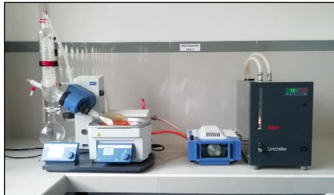
Figura 16: Muestra colocada en el rotavapor para evaporación y concentración
