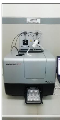
Figura 24: Lector multifuncional, usado para determinar azúcares reductores
