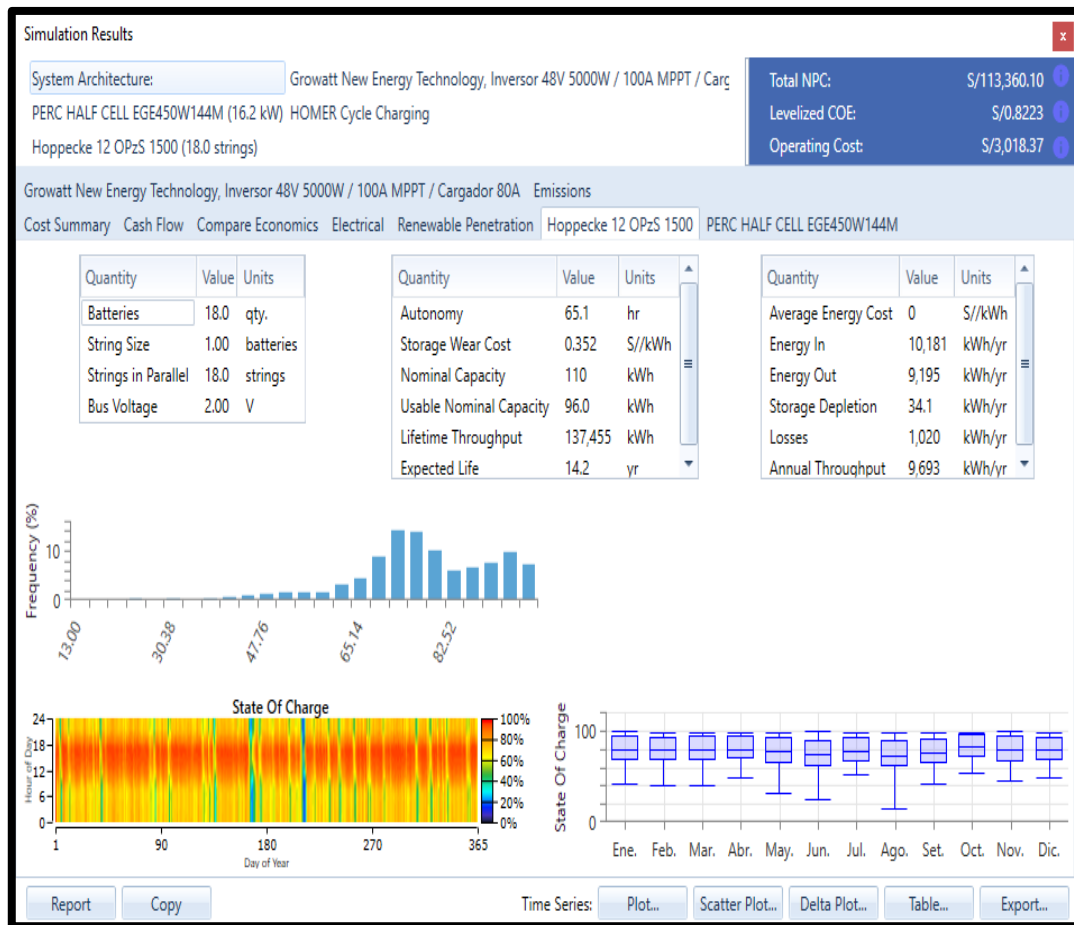
Figura 74: Generación de Energía de las Baterías del Sistema Fotovoltaico
