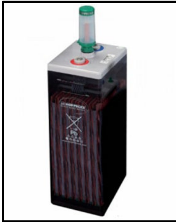
Figura 26: Batería Hoppecke 12 OPzS 1500, 2V 2232 A.h. (ANEXO 03)
