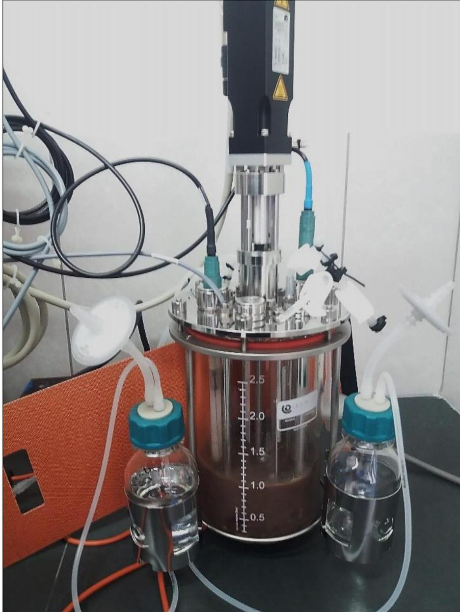
*Figura 19. Bioreactor (Marca Applikon, modelo Ez2-control) empleado en los experimentos de hidrólisis enzimática. Vaso del bioreactor conteniendo el hidrolizado líquido de anchoveta.*
