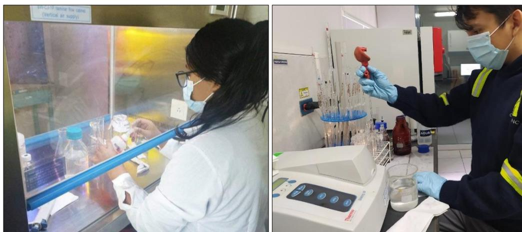
*Figura 17. Determinación de grado de hidrólisis por el método OPA. Preparación de las muestras y Lectura de absorbancia en espectrofotómetro para el análisis de los hidrolizados enzimáticos de anchoveta.*
