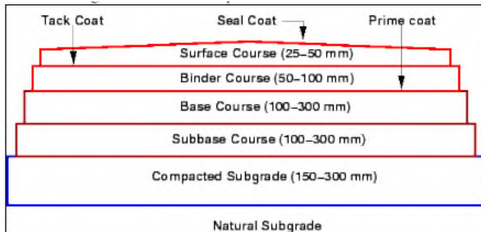
Figura 2. Sección de un Pavimento Flexible Convencional
