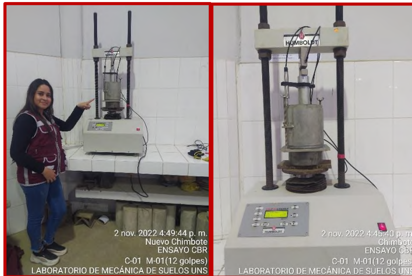
Foto 29. Ensayo de penetración en la prensa hidráulica de CBR, luego de 96 horas en agua
