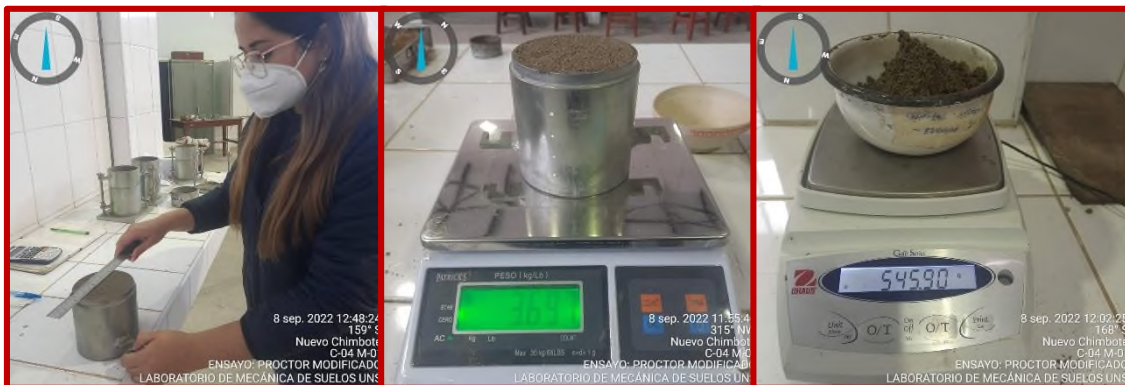
Foto 22. Enrasado, pesado de la muestra compactada y obtención de muestra representativa para determinar el óptimo contenido de humedad
