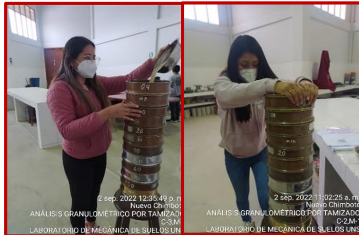
Foto 16. Realización de tamizaje de las muestras para determinar su análisis granulométrico
