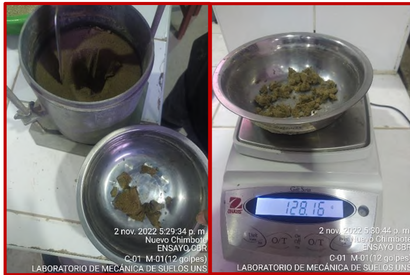
Foto 30. Toma de muestra de suelo después del ensayo de penetración, y posterior pesado para determinar su contenido de humedad
