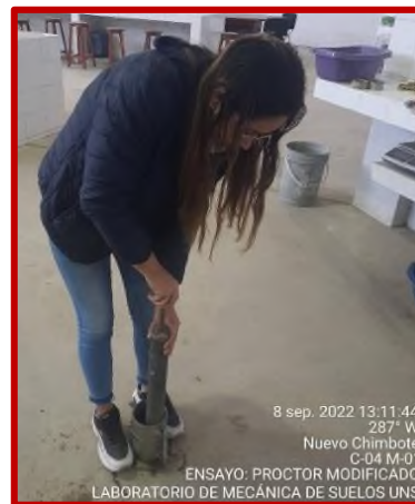
Foto 21. Compactación con Proctor Modificado
