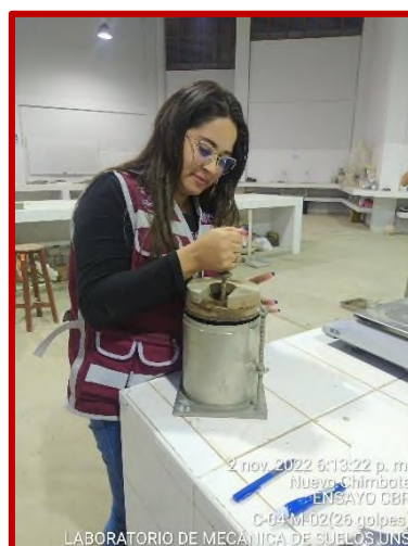
Foto 26. Colocación de sobre cargas anular, circular y placa perforada en molde CBR
