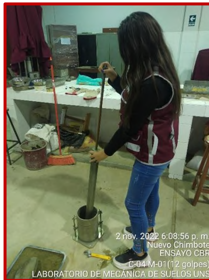
Foto 24. Compactación de la muestra de suelo con su óptimo contenido de humedad, haciendo uso del pisón para CBR
