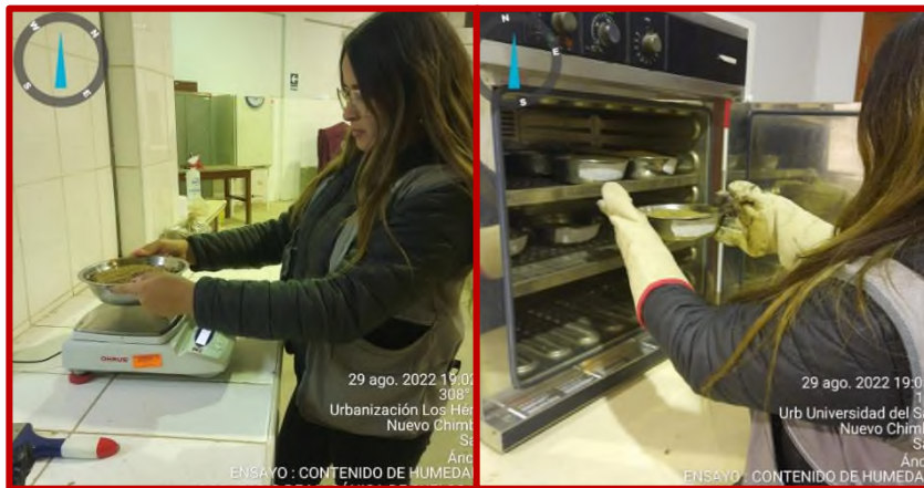
Foto 11. Determinación del contenido de humedad, peso de la muestra y colocación en el horno
