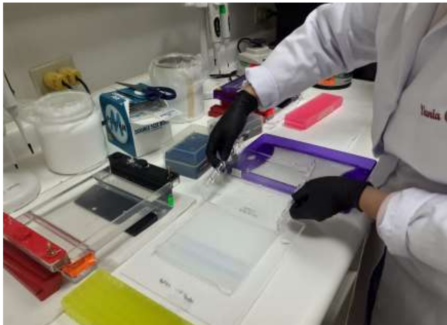
Preparación de migración electroforética para validación de especificidad de productos de amplificación de miR-21 y miR-16.
