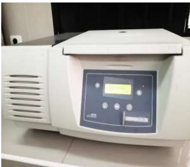
Centrífuga Refrigerada de rotor oscilante modelo Digicen 21 R (OrtoAlresa- Daganzo de Arriba, Madrid, España) del Laboratorio de Bioprocesos del IITA-UNS.
