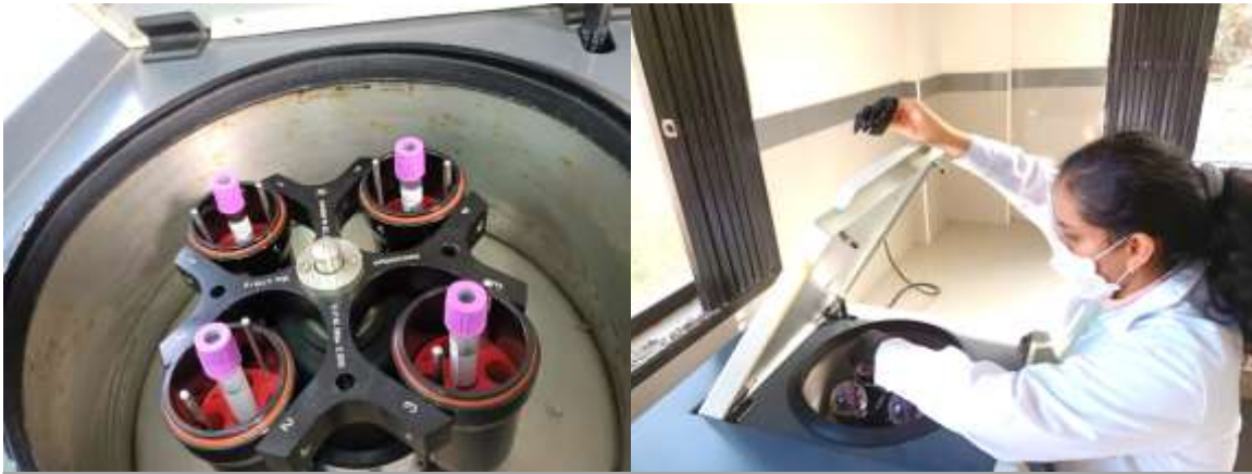
Centrifugación de muestras de sangre a 1440 x g por 10 min a 4°C, para separación de plasma sanguíneo
