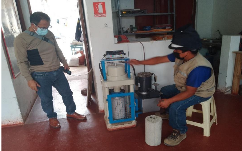
FOTO N°48 se observa la rotura de probeta en laboratorio para ver la resistencia de concreto
