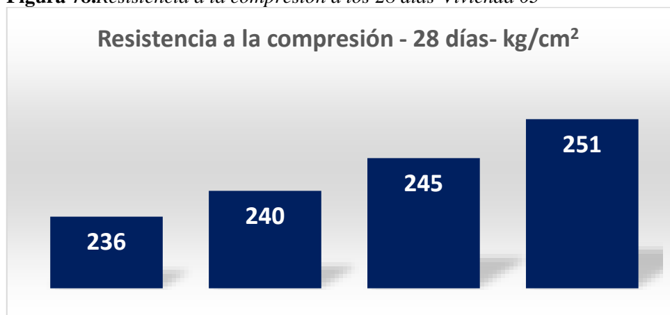
Figura 78. Resistencia a la compresión a los 28 días-Vivienda 03
