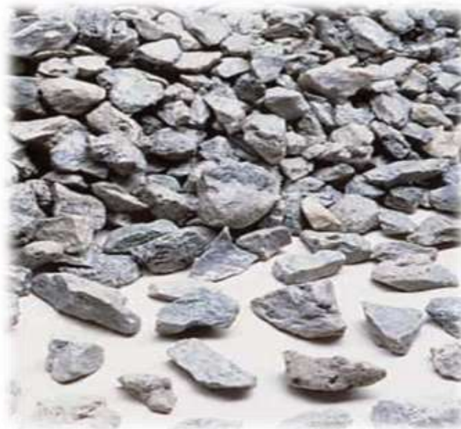
Figura 5. Agregado grueso depositado en obra.
