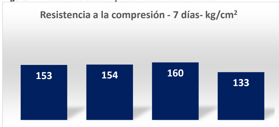
Figura 111. Resistencia a la compresión a los 7 días-Vivienda 20
