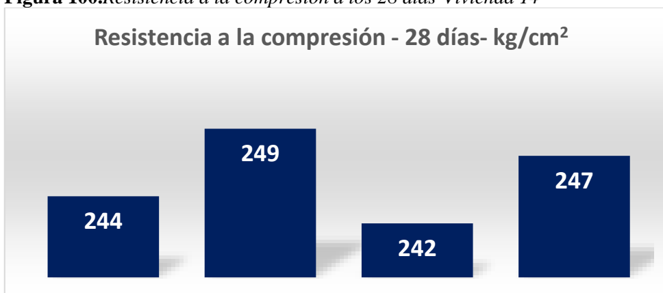
Figura 100. Resistencia a la compresión a los 28 días-Vivienda 14
