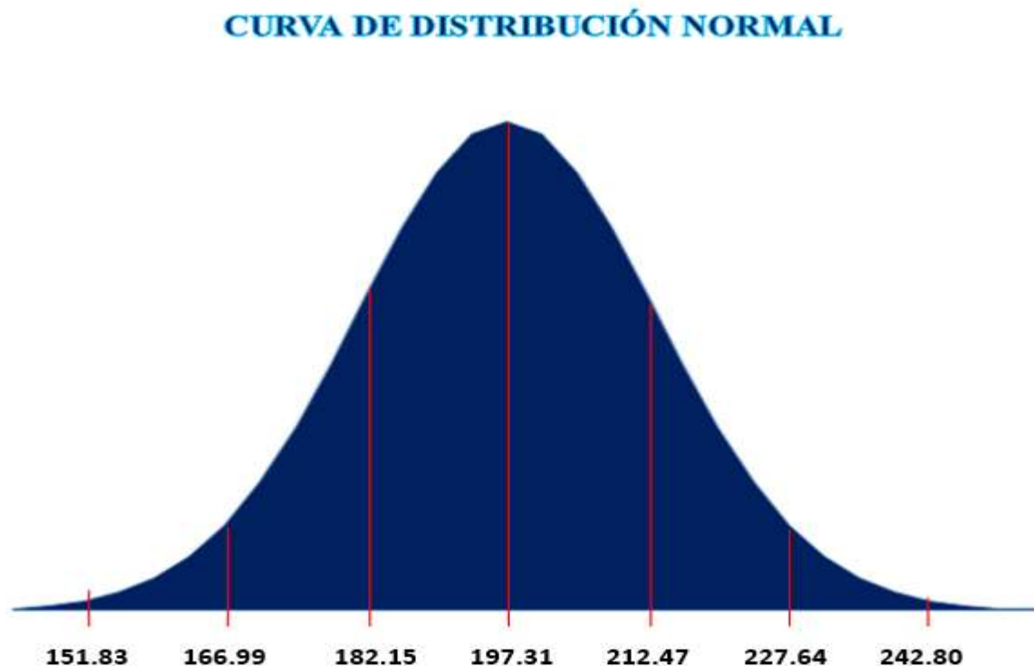
Figura 72. Curva de distribución normal del concreto estructural antes de la capacitación.
