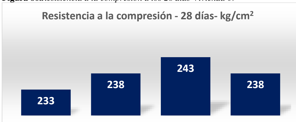
Figura 86. Resistencia a la compresión a los 28 días-Vivienda 07
