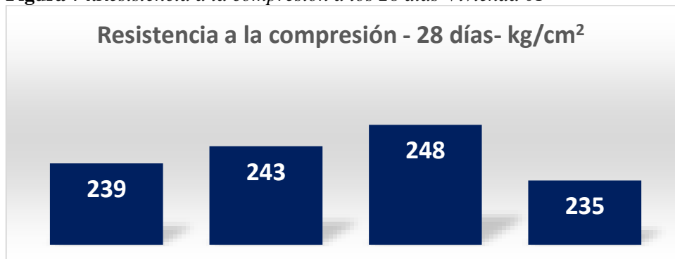
Figura 74. Resistencia a la compresión a los 28 días-Vivienda 01
