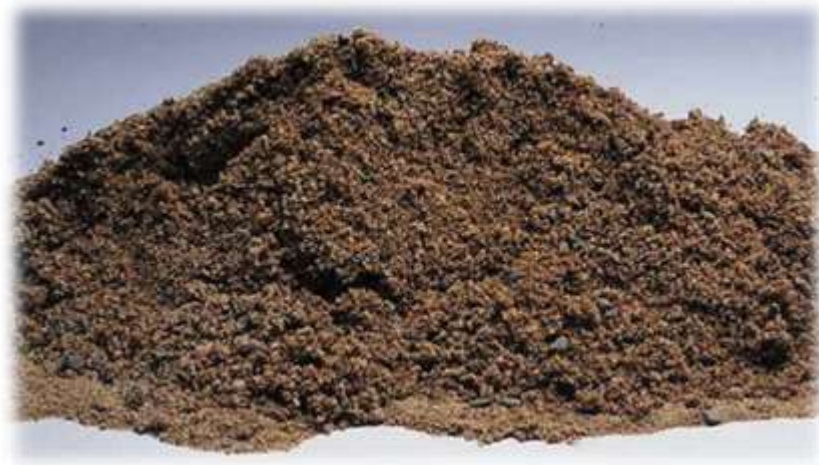
Figura 4. Agregado fino depositado en obra
