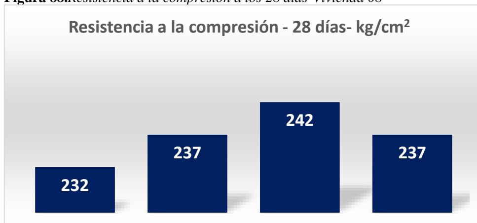
Figura 88. Resistencia a la compresión a los 28 días-Vivienda 08
