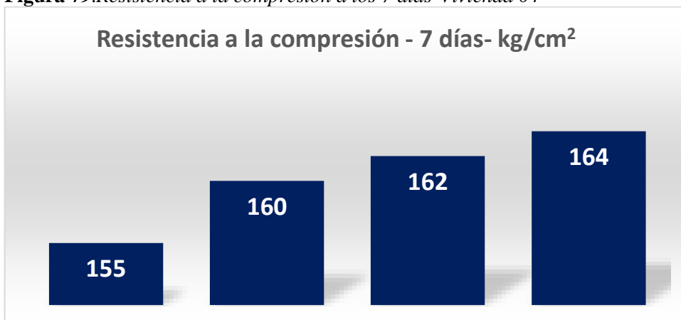
Figura 79. Resistencia a la compresión a los 7 días-Vivienda 04
