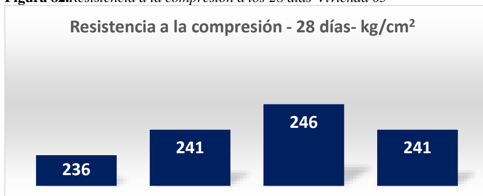
Figura 82. Resistencia a la compresión a los 28 días-Vivienda 05
