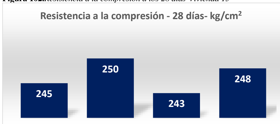
Figura 102. Resistencia a la compresión a los 28 días-Vivienda 15
