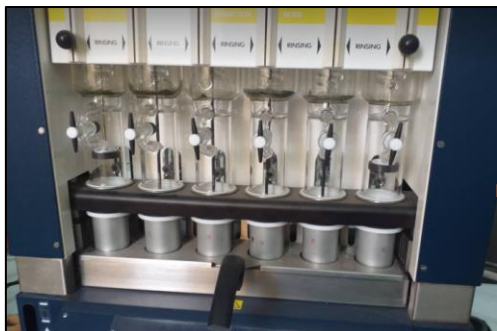
Colocar dentro del cartucho y ponerlo en el extractor con el solvente
