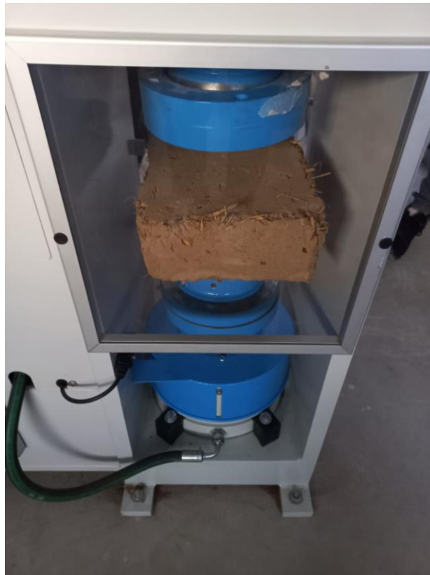
Foto 09: Ensayo de resistencia a la compresión del adobe
