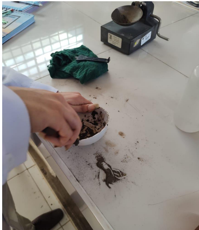
Foto 03: Ensayo de límite líquido de la arcilla
