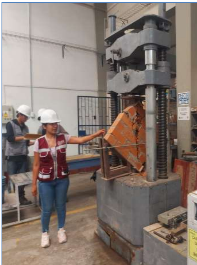
Figura 16 Resistencia a la compresión diagonal de muretes.
