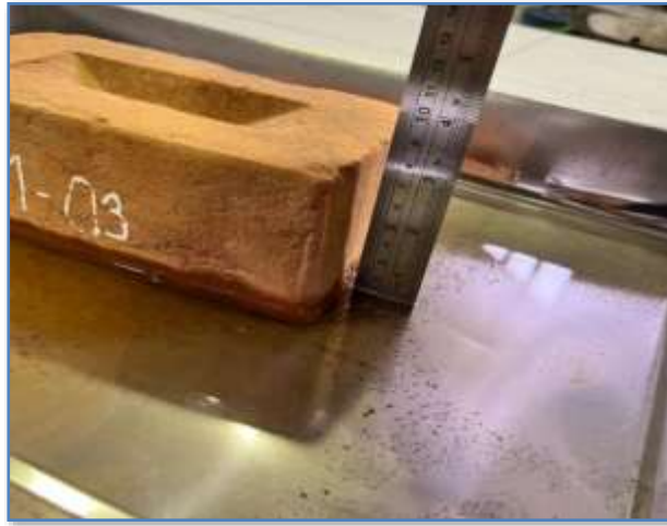
Figura 12 Succión del ladrillo de arcilla.
