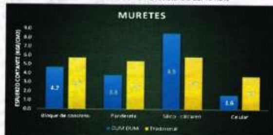
Gráfica N°2: Resultados de los ensayos de corte en muretes de albañilería (v' m)
