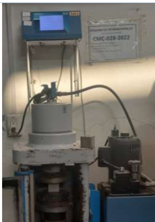
FOTOGRAFÍA N°44 Ensayo de compresión a la resistencia de los cubos de mortero.
