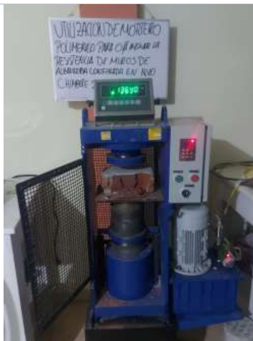
FOTOGRAFÍA N°43 Ensayo de resistencia a la compresión de la unidad de albañilería de arcilla artesanal.
