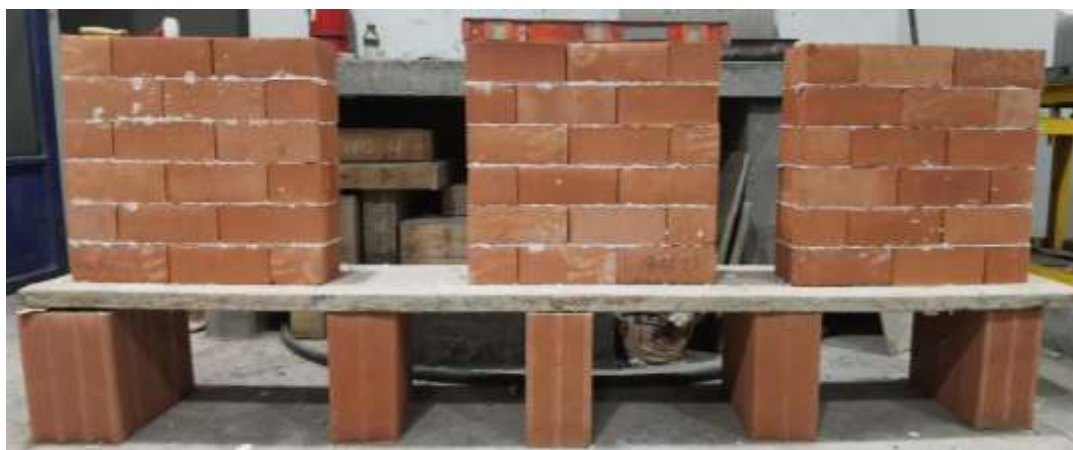
FOTOGRAFÍA N°48 Muestras de muretes con ladrillo industrial y mortero polimérico.
