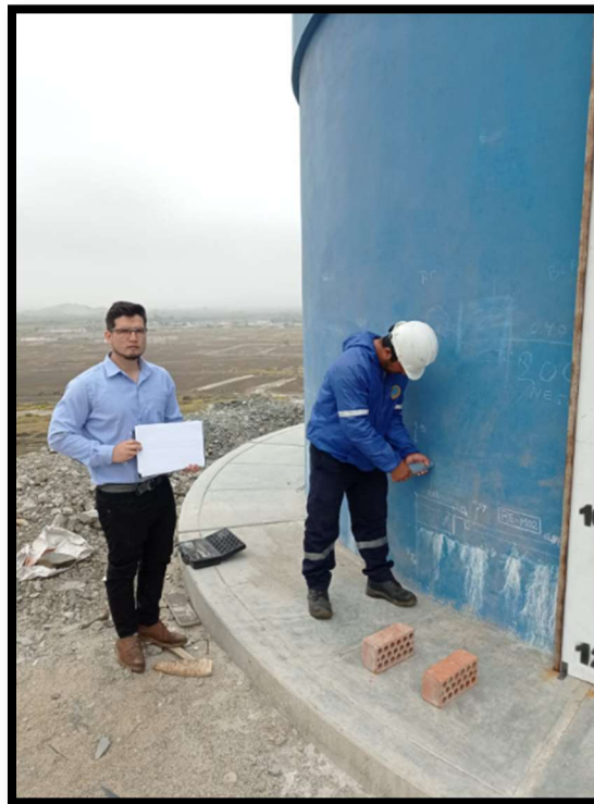
Foto 14: Ensayo no destructivo de esclerometría para estimar la resistencia del concreto en la unidad muestral más crítica en el reservorio
