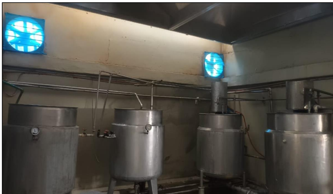
Figura 8: Marmitas para preparación de líquido de gobierno.
