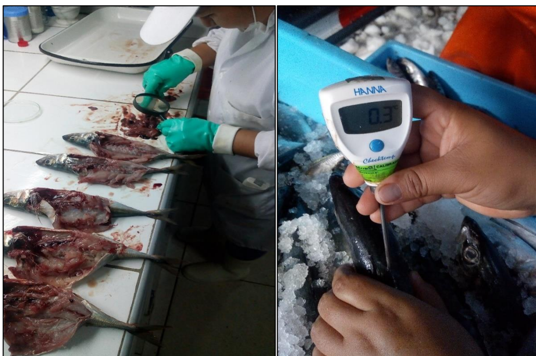
Figura 15: Análisis de materia prima, análisis físico-químico e histamina.
