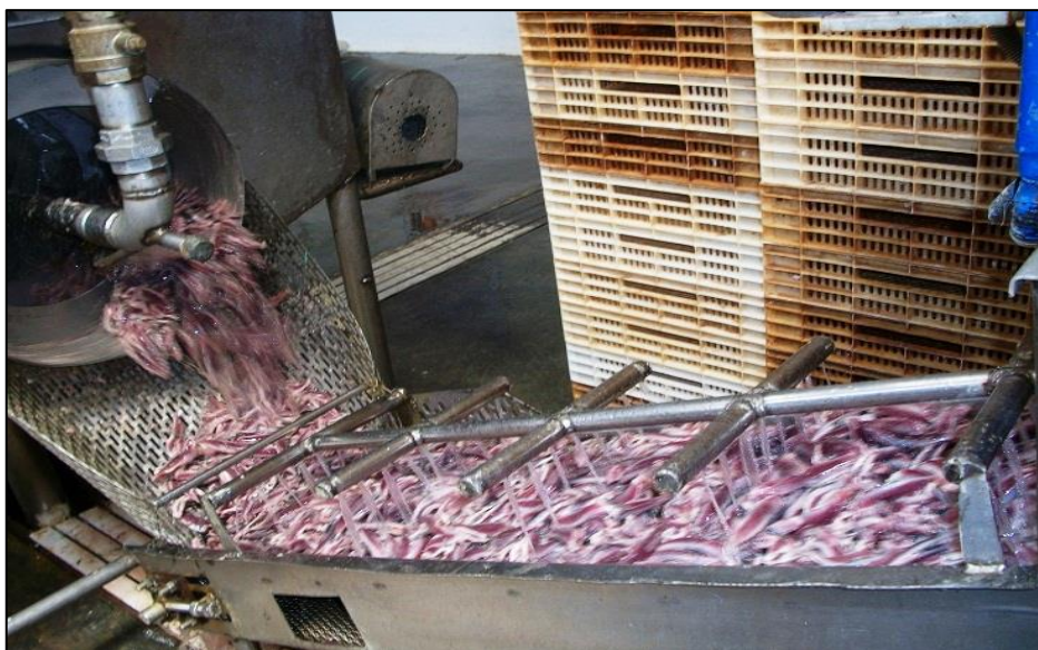
Figura 16: Peladora de Anchoveta (Engraulis ringens).
