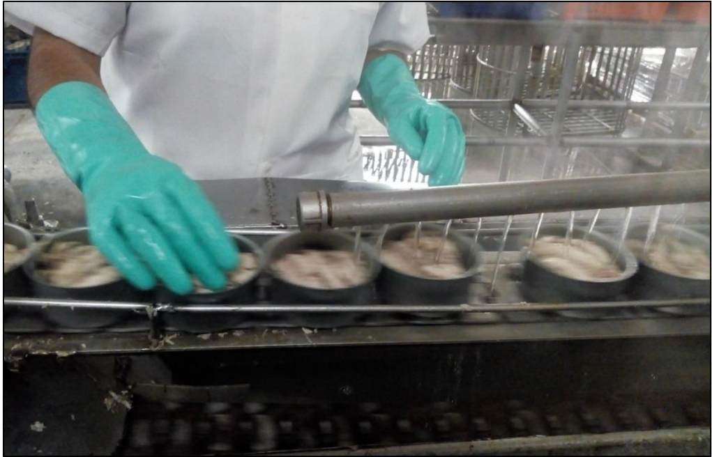
Figura 28: Adición de líquido de gobierno (línea cocido).
