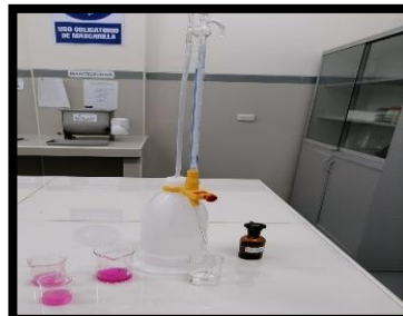
Medir Acidez (%) usando NaOH 0.1N
