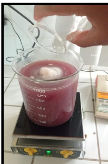
Figura 40 Dosificación del polvo de semilla de moringa al agua de sanguaza
