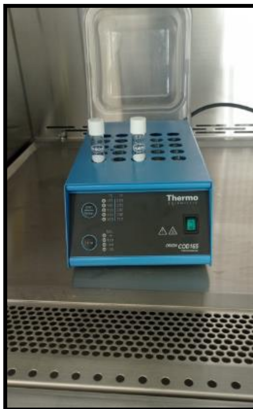
Figura 31 Determinación de Demanda Química de Oxígeno
