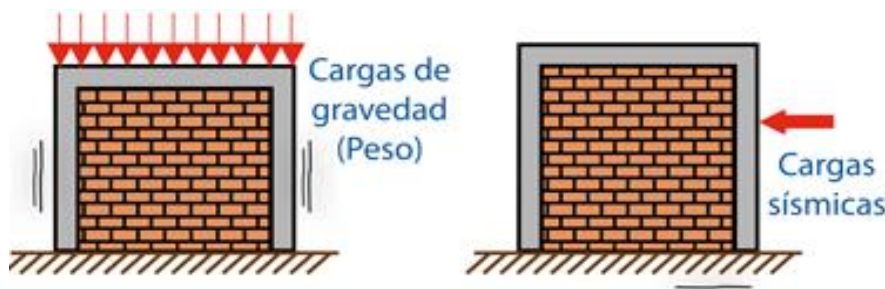
Figura 18 Cargas en el muro portante.
