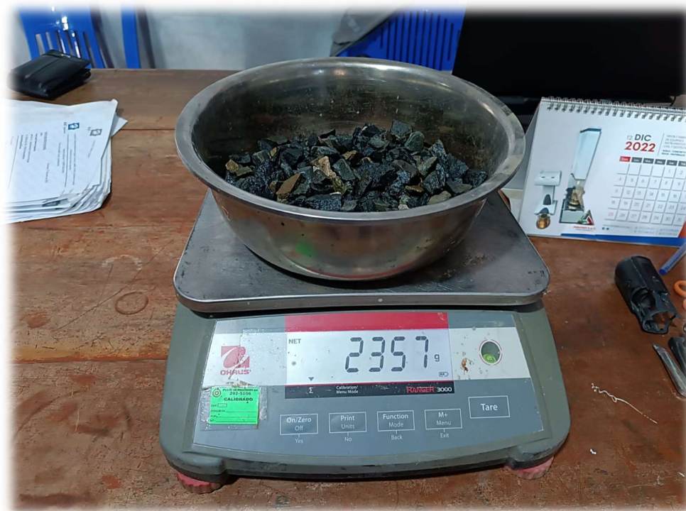
Figura 7 Ensayo para determinar la durabilidad al sulfato de sodio y al sulfato de magnesio
