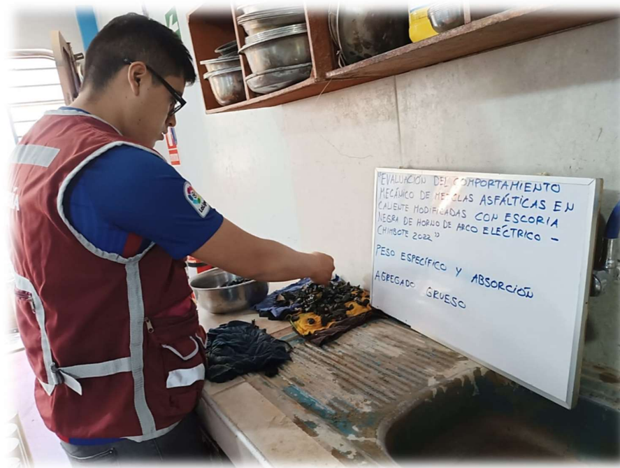
Figura 12 Ensayo para determinar el peso específico y absorción del agregado grueso.
