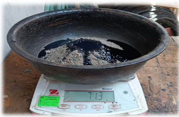
Figura 3 Preparación de mezcla asfáltica en caliente
