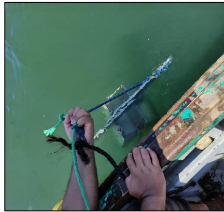
9. b) Toma de muestras de sedimentos marinos con la draga.
