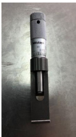
Anexo 80. Micrómetro para medición de espesor.
