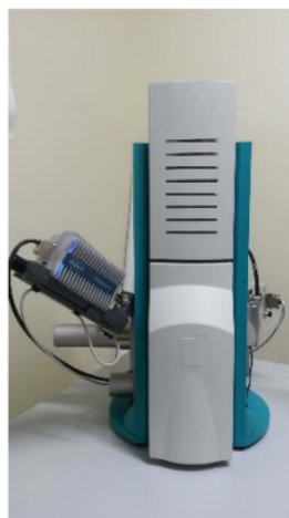
Anexo 85. Equipo Microscopia Electrónica de Barrido.
