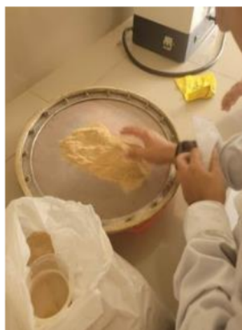
Anexo 47. Tamizado de Cascarilla de arroz molido.
