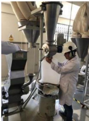
Anexo 53. Molienda de bagazo de caña de azúcar.
