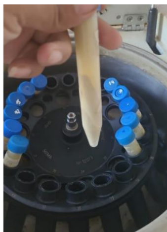
Anexo 38. Centrifugado del concentrado de almidón de semilla de mango.
