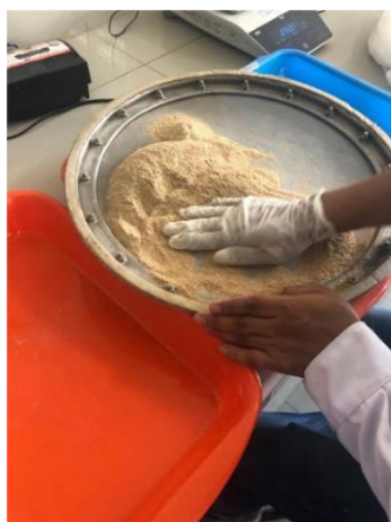
Anexo 54. Tamizado del bagazo de caña de azúcar molido.
