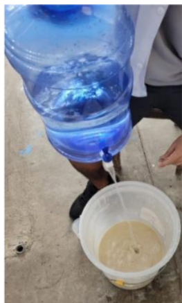
Anexo 36. Lavado del concentrado de almidón de semilla de mango.
