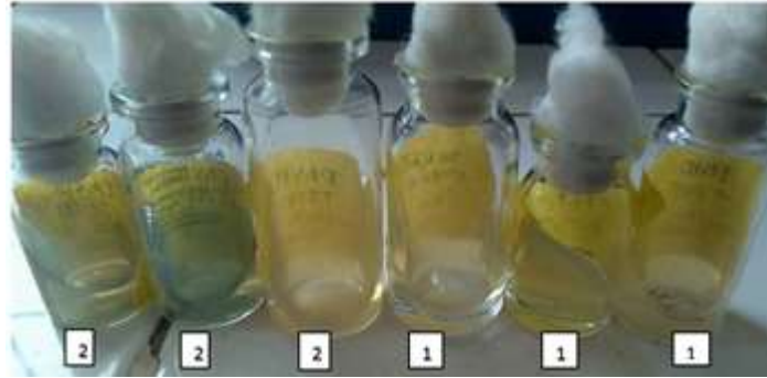
Figura 7. Viales con medio agar nutritivo N°1 a 445ppm y N° 2 a 144 ppm cadmio inoculados con Pseudomonas putida .
