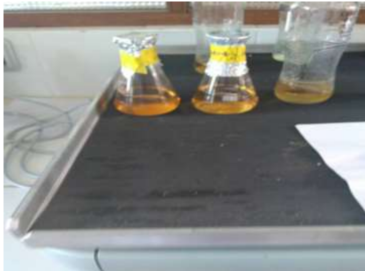
Figura 5. Caldo nutritivo con el pre inóculo en agitación a 150 rpm a temperatura ambiente.
