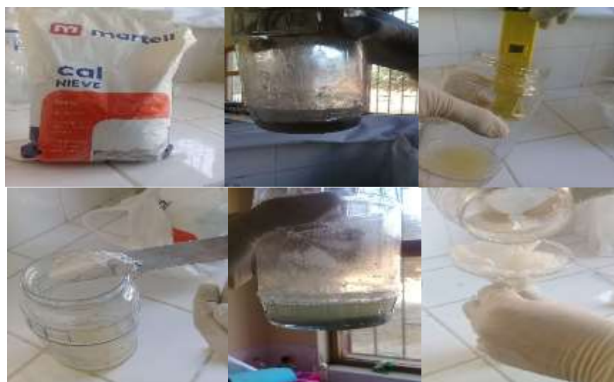
Figura 16. Proceso de Neutralización con Cal Hidratada
