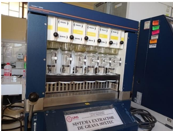
Figura 50. Equipo extractor de grasa FOSS.
