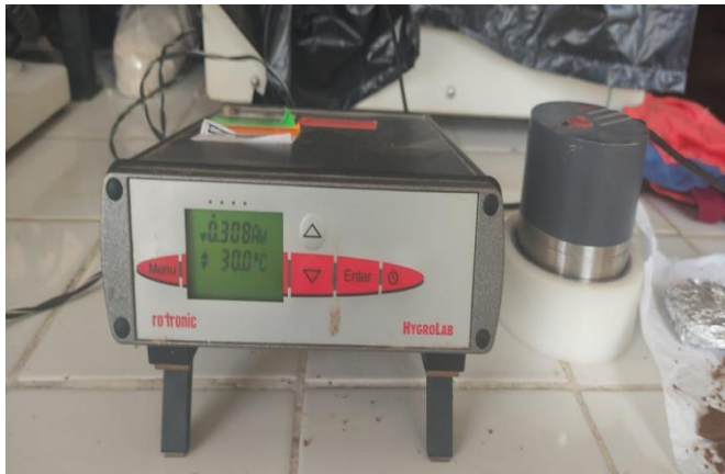
Figura 69. Determinación de actividad de agua en la cookie óptima.
