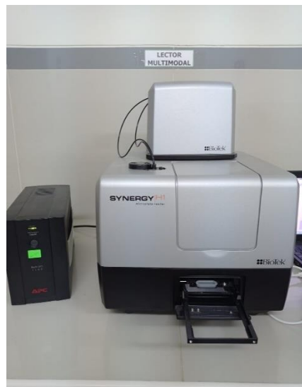
Figura 75. Equipo lector multimodal para contenido de polifenoles.
