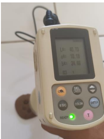
Figura 61. Determinación de color instrumental con colorímetro.
