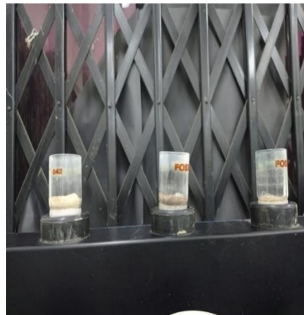
Figura 58. Contenido de fibra resultado de la filtración.
