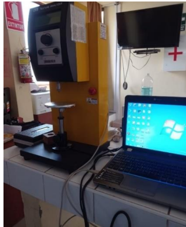
Figura 62. Texturometro Texture AnalyZer para analisis de textura instrumental.
