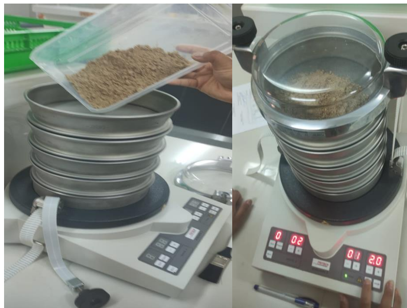
Figura 64. Medición de granulometría en tamizador eléctrico.
