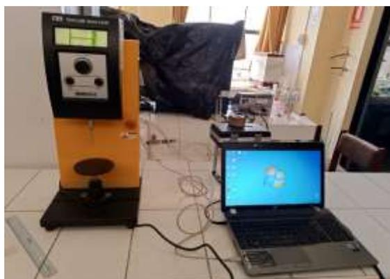
**Figura 56.** Equipo texturómetro BROOKFIELD
