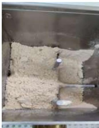
**Figura 42.** Mezclado y amasado de las harinas en el equipo pastaia
