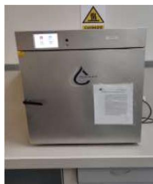
**Figura 47.** Determinación de humedad por el método de la estufa
