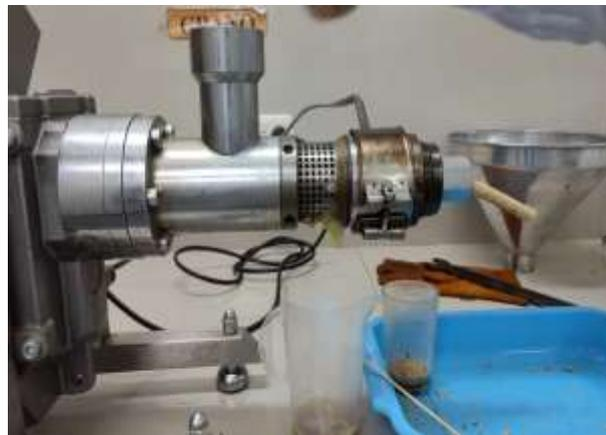
**Figura 34.** Proceso de desgrasado en el equipo expeller-prensa en frío
