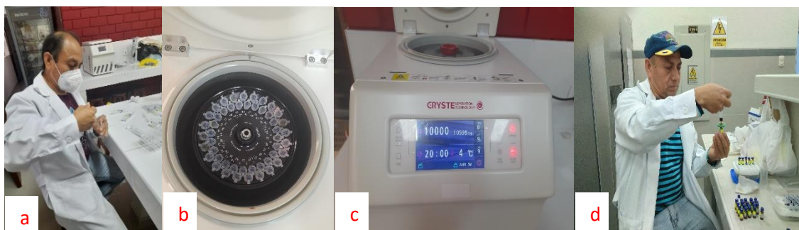
Figura 22: Acondicionamiento de muestras para la determinación de porcentaje de etanol por cromatografía de gases. a. muestras triplemente centrifugadas son trasvasadas con jeringa, b. muestras en el rotor del equipo, previamente rotuladas, c. Microcentrifuga refrigerada a 10 000 rpm por 20 min., d. doble filtrado de muestras.
