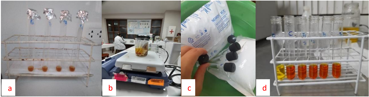
Figura 21: Determinación de azúcares reductores por el método de Miller 3,5- dinitrosalicílico (DNS). a. Dilución del mostro dada la turbidez de la melaza, b. una vez agregado el reactivo a ebullición, c. luego al frío del hielo, d. muestras listas para ser medidas por el espectrofotómetro.
