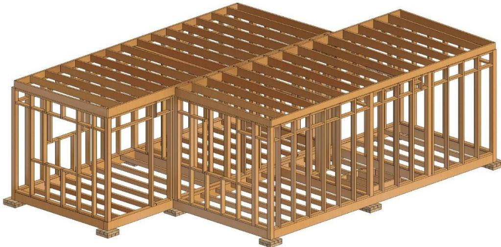
La cimentación de las unidades modulares estuvo constituida sobre apoyos de madera de 300mm x 300mm x 120mm sobre un terreno previamente nivelado y compactado. Los pisos presentaron una estructura compuesta por una base y un marco con perfiles de madera de
