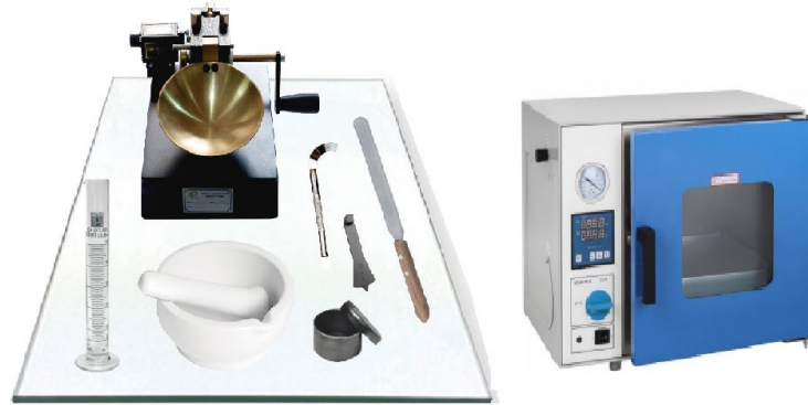
Figura 15 Materiales para el empleo del límite líquido
