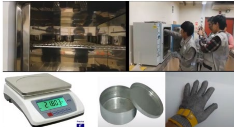
Figura 14 Materiales para el empleo del contenido de humedad
