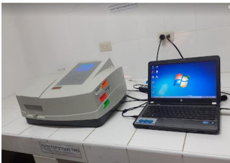
*Figura 38. Equipo para la determinación de Vitamina C.*
