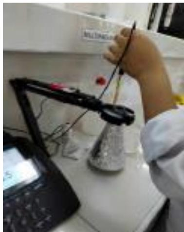
*Figura 48. Ajuste del pH del Metanol con HCL.*
