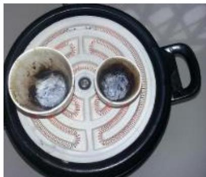
*Figura 31. Carbonización de la muestra.*
