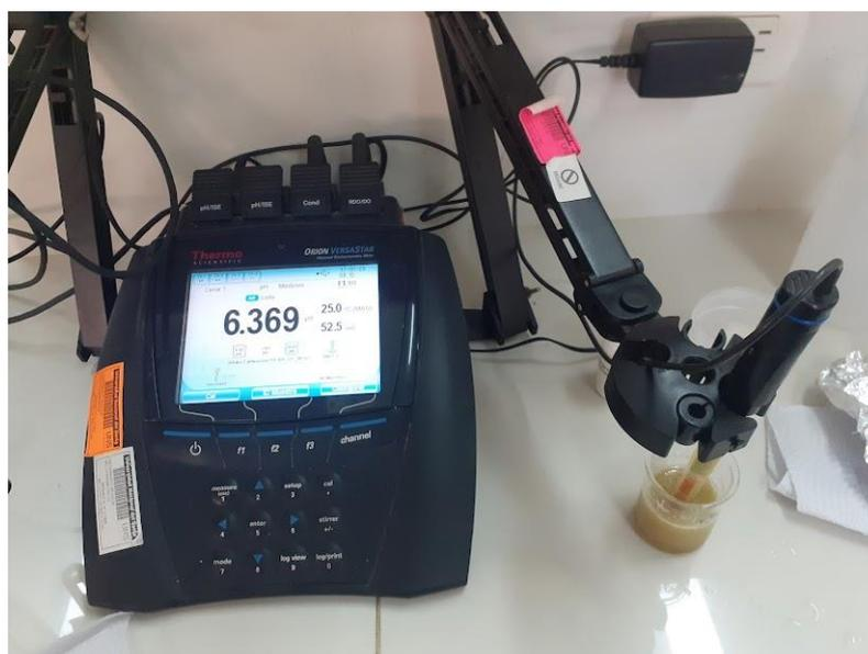
*Figura 34. Determinación de pH del Yacón.*
