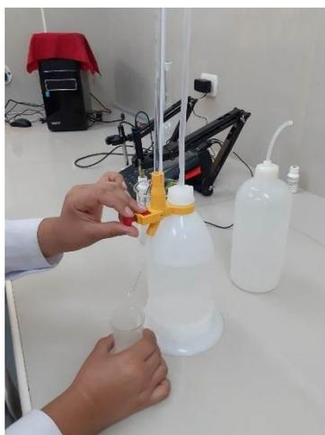
*Figura 22. Titulación con Hidróxido de sodio 0.1N.*
