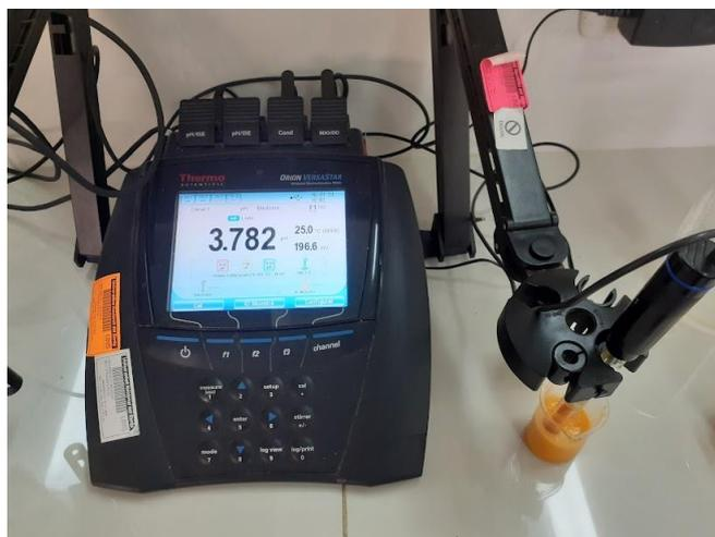
*Figura 33. Determinación de pH del Aguaymanto.*
