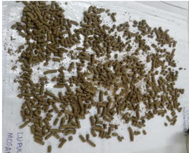
Figura 23. Secado de pellets repeletizados a temperatura ambiente.
