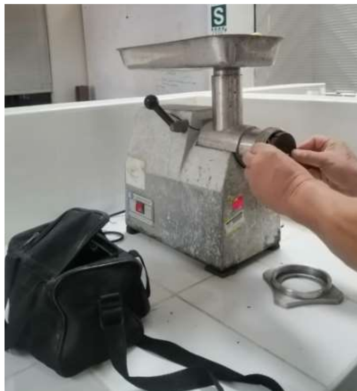
Figura 17. Armado de las piezas del equipo peletizador
