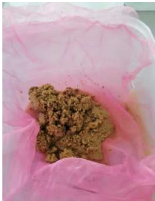
Figura 15. Residuo de lúpulo (pasta residual) obtenido después de exprimir.
