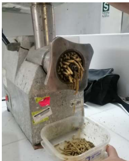
Figura 22. Obtención de pellets repeletizados
