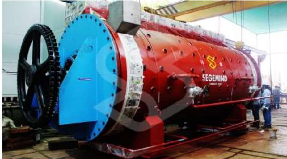
Figura 3: Secador Rotadisk
