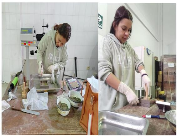
Foto 12 Y 13: Preparación de la muestra para realizar el ensayo de corte directo en el laboratorio de mecánica de suelos de la UNS.
