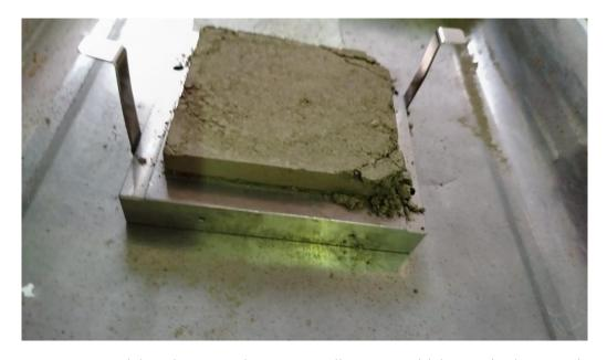
**Foto 16:** Muestra del suelo ensayado por corte directo, en el laboratorio de mecánica de suelos de la UNS.
