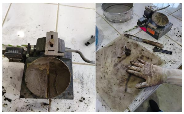
**Foto 10 y 11:** Ensayos de los límites de Attemberg y copa Casagrande en el laboratorio de mecánica de suelos de la UNS.
