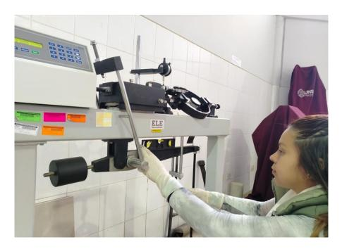
**Foto 14:** Manipulación de la maquina de ensayo de corte directo, nivelación de los discos de carga para realizar el ensayo, en el laboratorio de mecánica de suelos de la UNS.
