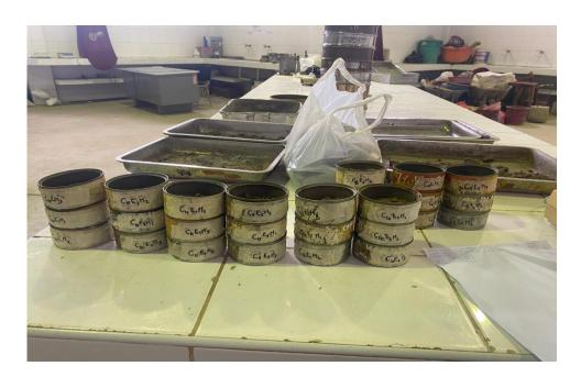
**Foto 08:** preparación de las muestras para realizar el contenido de humedad en el laboratorio de mecánica de suelos de la UNS
