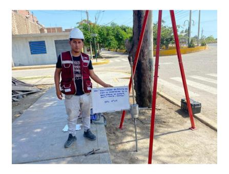
Foto 04: realización del ensayo de DPL en la zona 9
