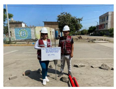
Foto 05: Realización del ensayo de DPL en la zona 01
