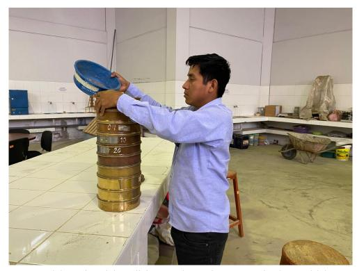
**Foto 06:** elaboración del análisis granulométrico por tamizado en el laboratorio de mecánica de suelos de la UNS.
