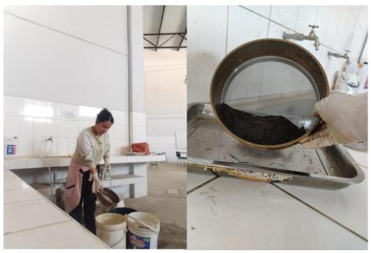
**Foto 07:** Elaboración del análisis granulométrico por lavado en el laboratorio de mecánica de suelos de la UNS.
