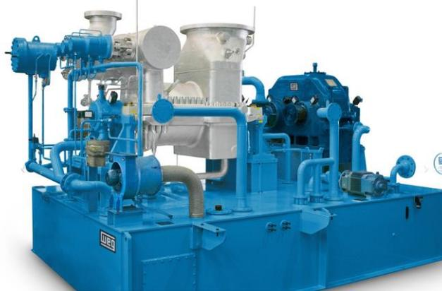
La línea TM, son turbinas de contrapresión, que poseen una regulación controlada de vapor y múltiples etapas, con el fin de poder soportar accionamientos con un alto nivel de rendimiento, que estén sometidos a diferentes parámetros de presión y temperaturas de vapor.
