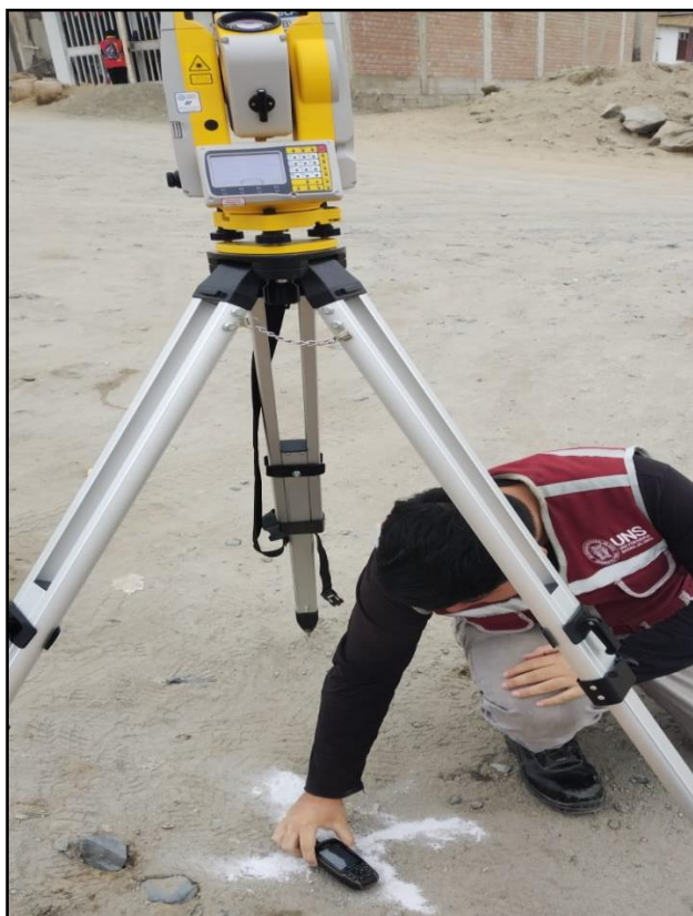
FOTO 3: Georreferenciación con GPS Garmin GPSMAP 65S MULTI-BAND
